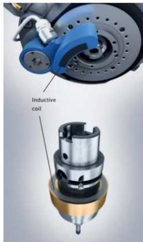
Obr. 3.3.3 Detail vřetena a nástroje – přenos ultrazvukových kmitů pomocí indukce [17].
