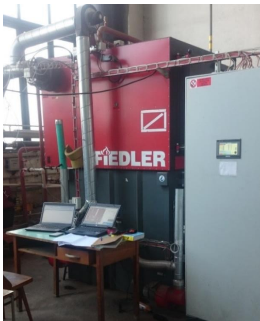
Obr. 11 - Kotel s experimentální recirkulační tratí
