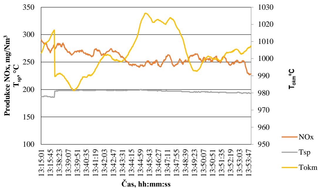
Obr. 33 – Experiment S4 - 60 % recirkulovaných spalin do primární trati
