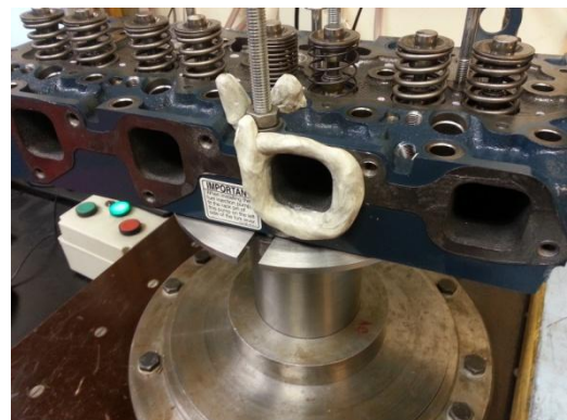
Obr. 22 – Úprava vstupu do sacího kanálu pomocí plastické hmoty
