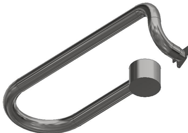
Obr. 39 – Detail sacího potrubí 3
