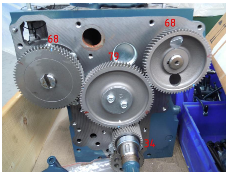
Obr. 58 – Počet zubů jednotlivých kol v hlavě motoru [h]
