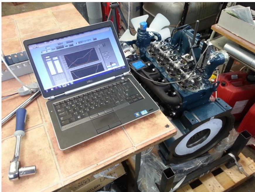
Obr. 18 – Měřicí stanoviště pro měření zdvihů ventilů
