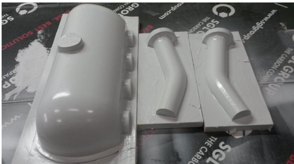
Obr. 45. Lakované a vybroušené kopyta forem.
