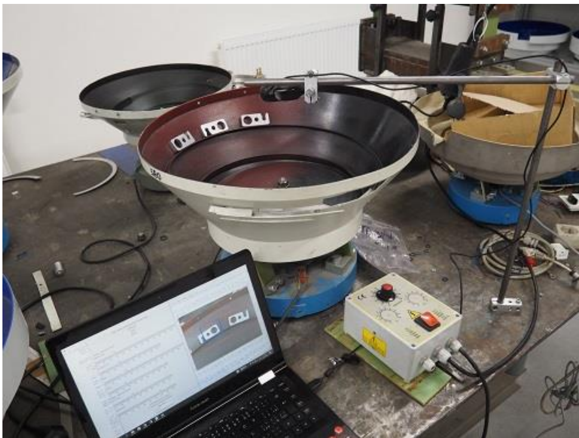
43 - Zobrazení stojanu s upevněnou kamerou u zkušebního zásobníku
