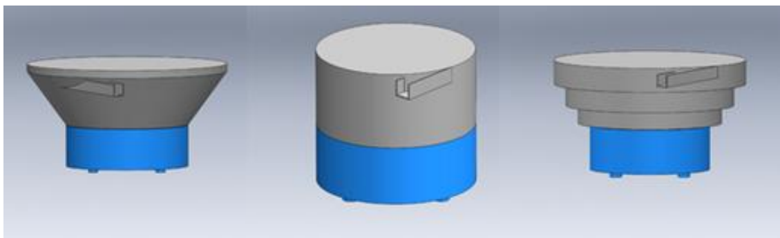
4 - Koncepční zobrazení kuželové, válcové a stupňovité varianty[2]
