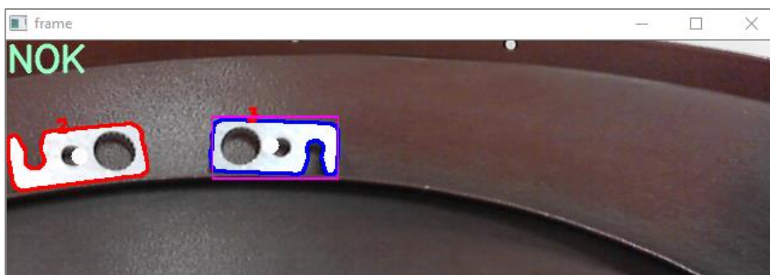
38 - Detekce NOK součásti (3) a označená NOK součást (2)
