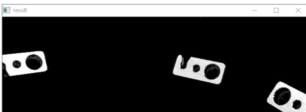
35 - Obrázek po separaci pozadí obsahuje pouze pohybující se součásti
