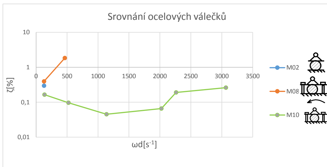
Obr. 5.5 Graf srovnání poměrného útlumu u ocelových válečků
