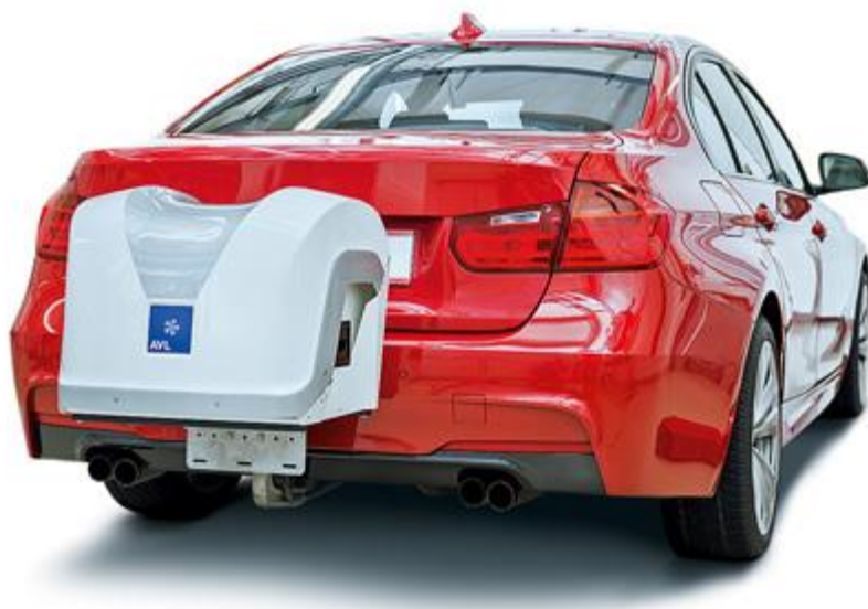
Obrázek 18: PEMS AVL MOVE připevněné na tažném zařízení
