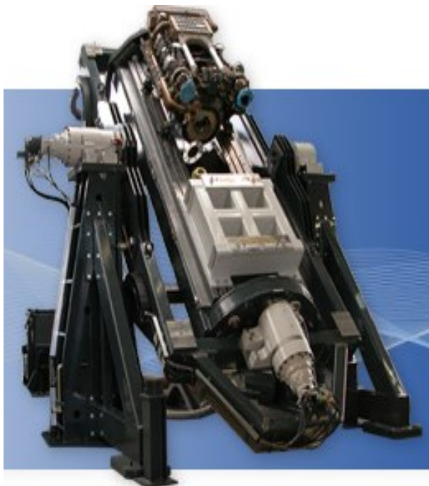
Obr. 2.3 Zařízení pro naklápění spalovacího motoru s dynamometrem [15]
