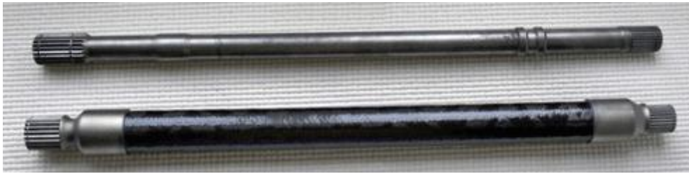
Obrázek 15 - Porovnání ocelové a kompozitní poloosy studentského vozu z The University of Warwick (2010)
