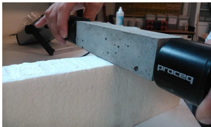
Obr. 53 – Zkoušení dynamického modulu pružnosti ultrazvukovou metodou
