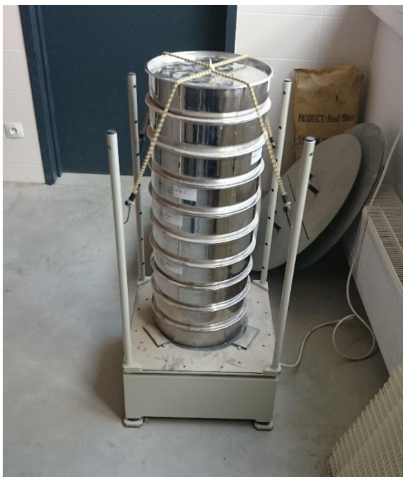
Obr. 10 – Elektro-magnetická prosévačka kameniva
