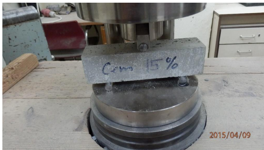
Obr. 23 – Zkouška pevnosti v tahu za ohybu
