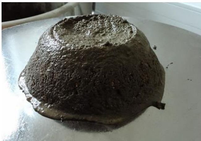
Obr. 38 – Zkouška zpracovatelnosti čerstvé betonové směsi
