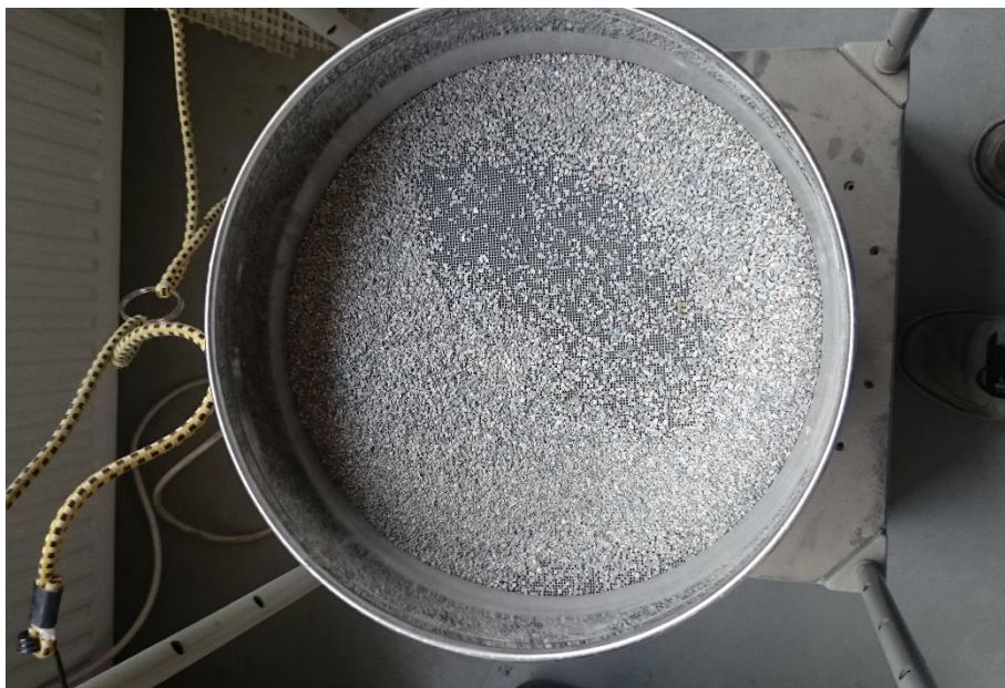
Obr. 26 – Recyklované kamenivo zachycené na sítu o velikosti otvorů 0,5 mm
