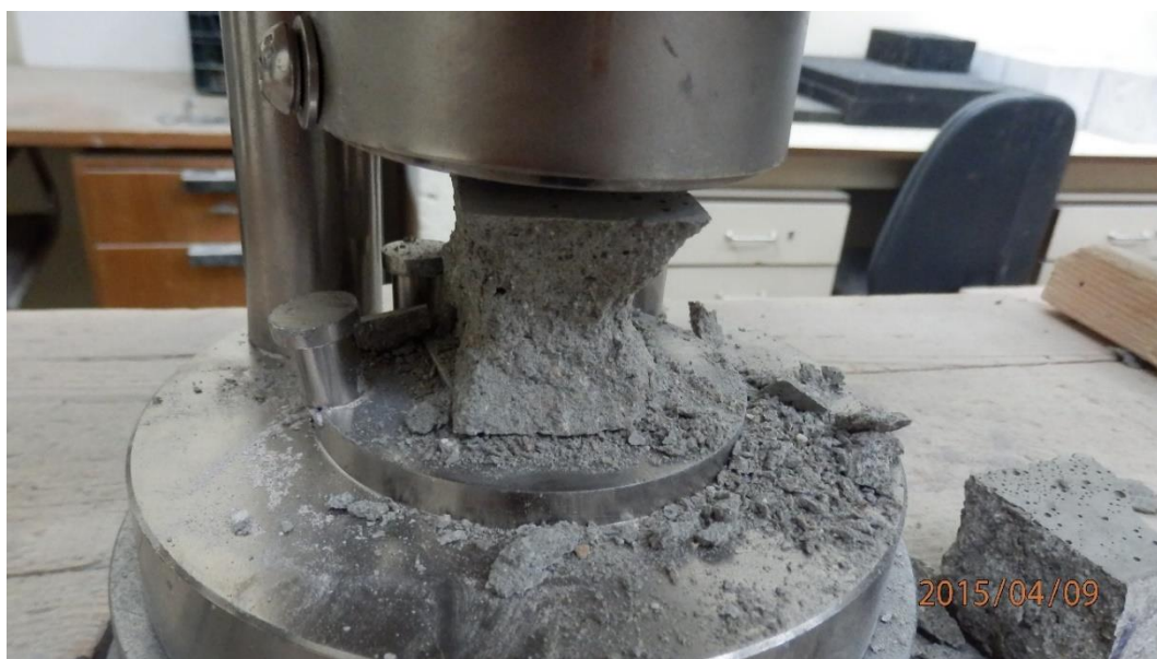
Obr. 54 – Zkouška pevnosti v tlaku
