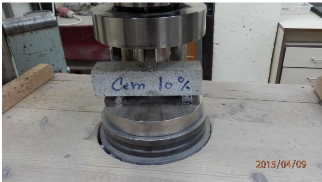
Obr. 61 – Hranol připravený na zkoušku pevnosti tahu za ohybu
