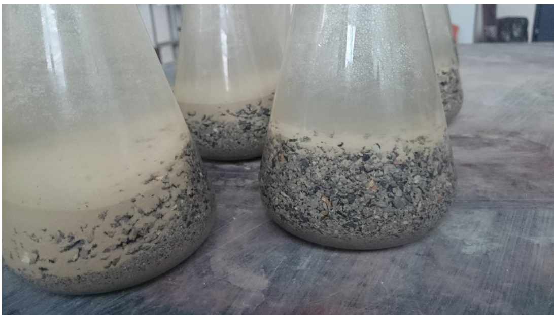
Obr. 31 – Pyknometrická zkouška jemného recyklovaného kameniva
