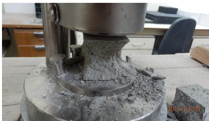
Obr. 21 – Zkouška pevnosti v tlaku
