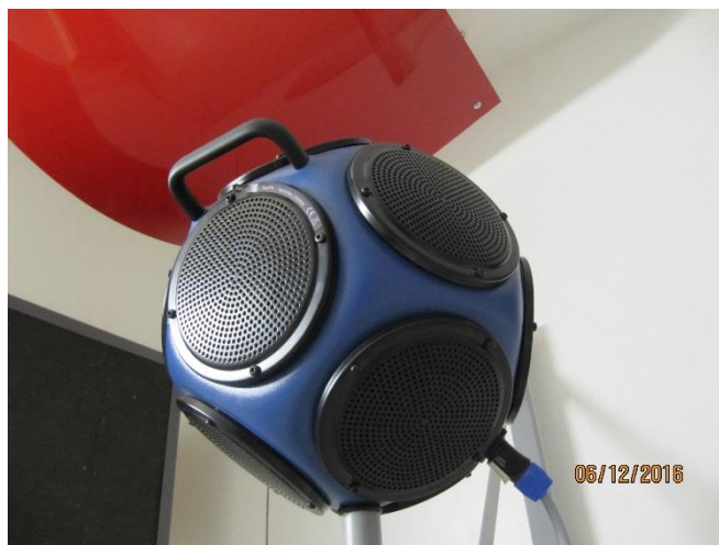
Obr. 4.2 – Všesměrový reproduktor Nor 276 od firmy Norsonic
