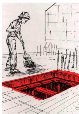
Obr. č. 23: Názorná ukázka zabezpečení otvorů [zdroj internet]
