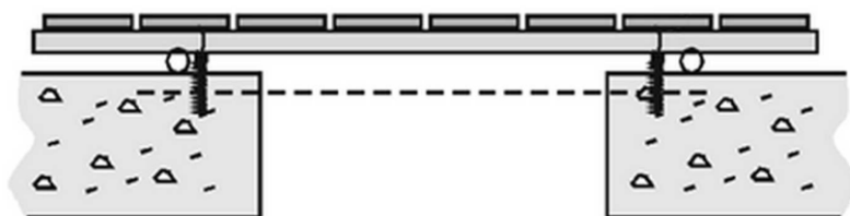
Obr. č. 22: OSB desky přidělané ke konstrukci [zdroj internet]
