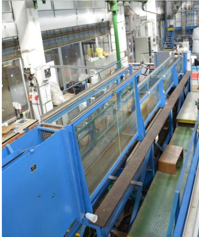
Foto 7.3 Celkový pohled na hydraulický žlab B
