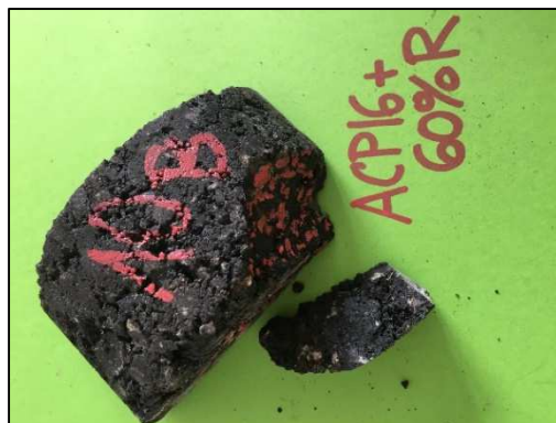
Obr. 28 Špatně porušené zkušební těleso ACP16+ R60% - 10B
