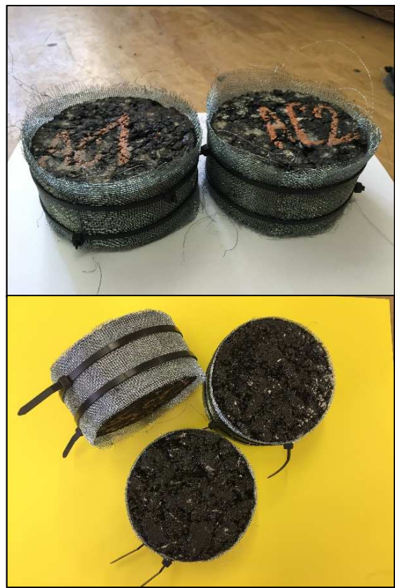
Obr. 9 Zkušební tělesa obalená ocelovou sítkou
