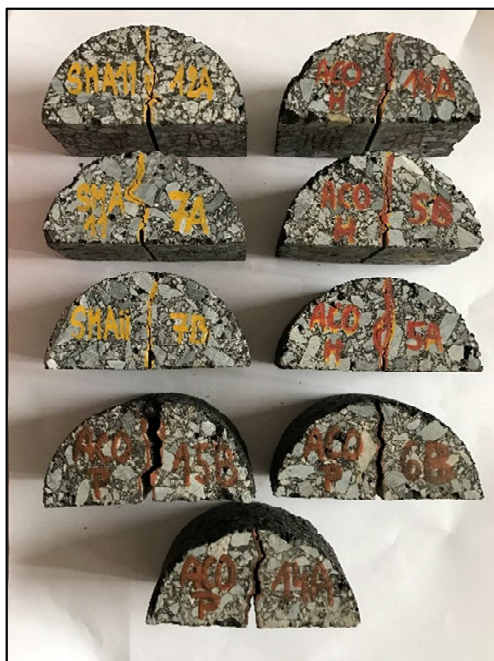
Obr. 22 Fotografie porušených zkušebních těles (ACO11S PMB, ACO11S 50/70, SMA11S PMB)
