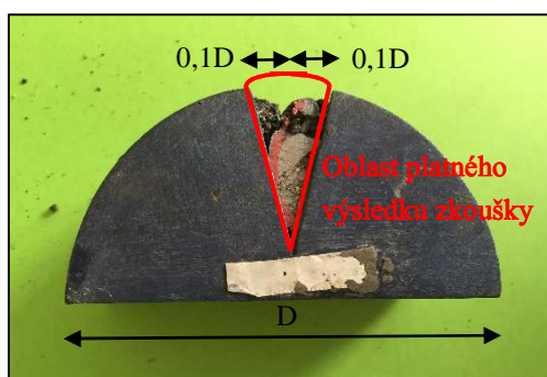
Obr. 20 Oblast platného výsledku zkoušky šíření trhlín
