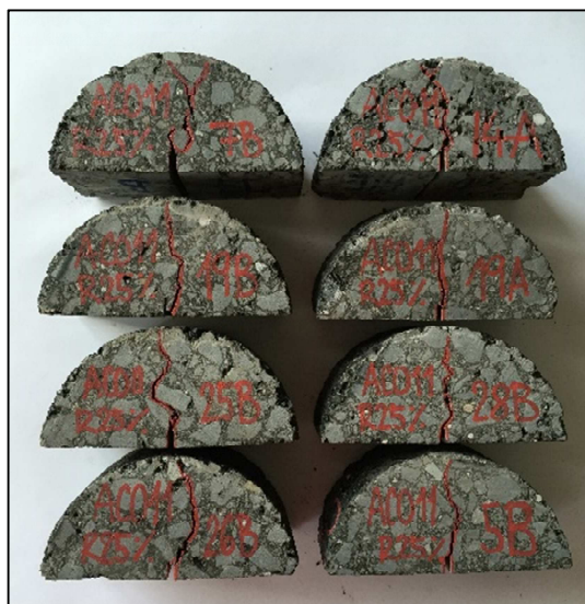
Obr. 25 Porušená zkušební tělesa asfaltové směsi ACO11 R25%
