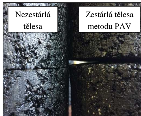
Obr. 10 Nezest\u00e1rl\u00e1 a zest\u00e1rl\u00e1 zkušební tělesa v PAV
