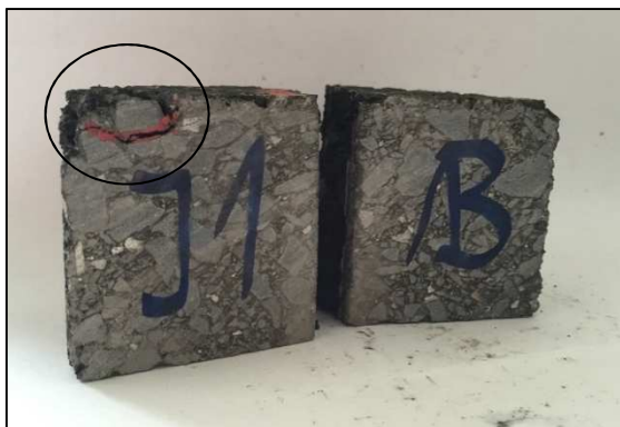
Obr. 27 Špatný vznik trhliny na zkušebním tělese ACO11 R25% - 1B
