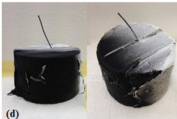
Obrázek 13: Příklad vzorku pro vytahovací zkoušku [11]
