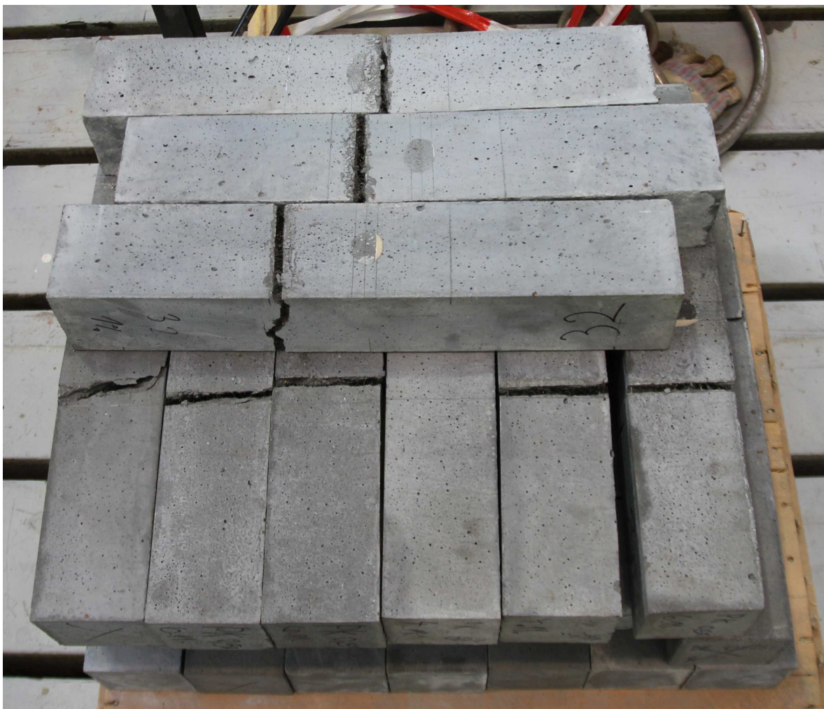
Obrázek 35: Vzorok porušené ohybem při kvazistatické rychlosti zatížení, pohled na jejich spodní a horní strany
