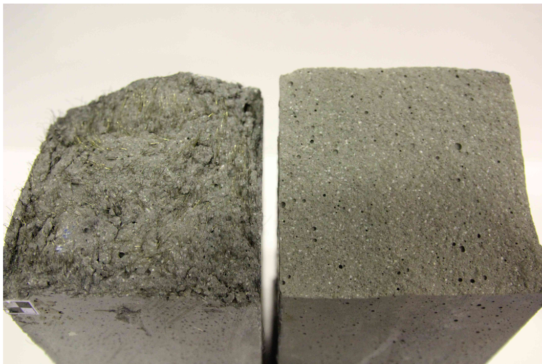
Obrázek 38: Rozdíl lomových ploch vzorku s 2% vyztužením a nevyztuženého vzorku
