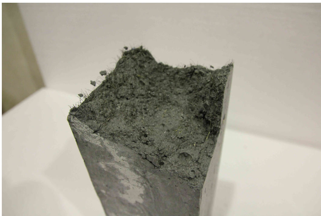
Obrázek 39: Detail lomové plochy pro vzorek s 2% vyztužením
