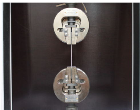
Obrázek 12: Tahová zkouška samostatného vlákna [24]
