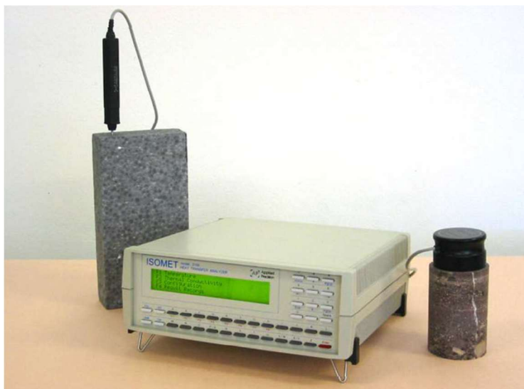
Obr. 10: Přístroj Isomet 2104 s jehlovou a plošnou sondou použitý při měření
