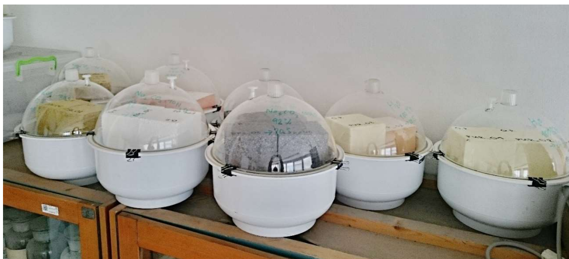
Obr. 11: Vzorky tepelných izolací umístěné v exsikátorech v různě vlhkých prostředích
