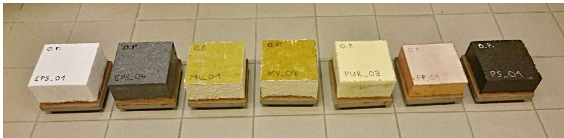
Obr. 8: Zkušební tělesa jednotlivých tepelných izolací připravená na zkoušky propustnosti vodních par (zleva EPS1, EPS2, MV1, MV2, PUR, FP, PS)
