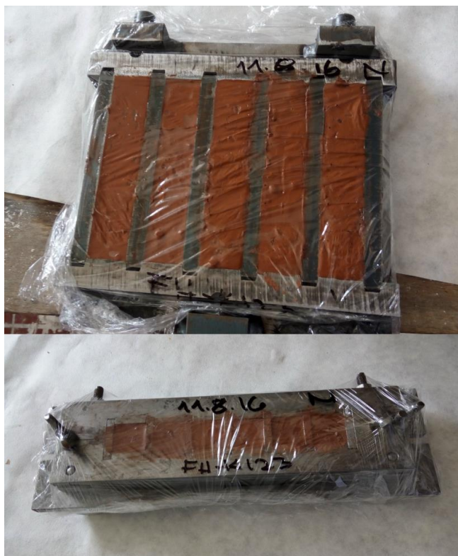
Obrázek 40. Naplněné formy přikryté folií
