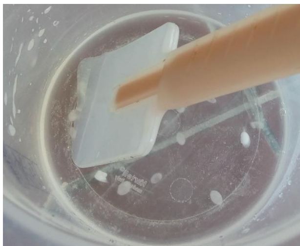
Obrázek 39. Rozpuštění NaOH v H 2 O [foto: Alblová Nikol]
