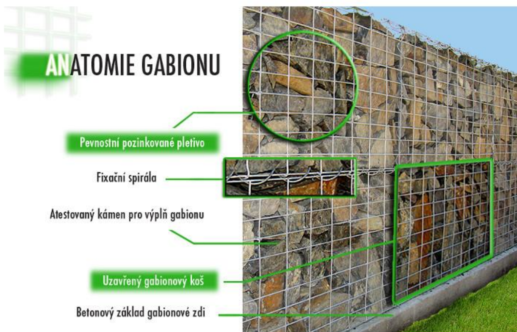
Obrázek 47: Anatomie gabionu
