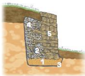
Obrázek 38: Opěrná zídka s drenáží
