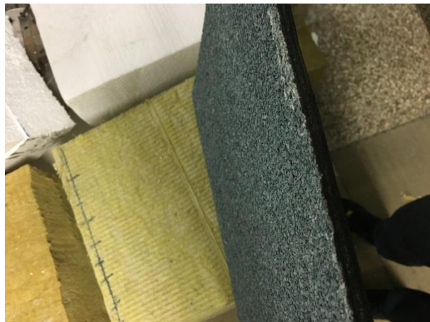
Obr. č. 8: Detail asfaltového pásu Elastek 40 Special Decor (tl. 4,5 mm)
