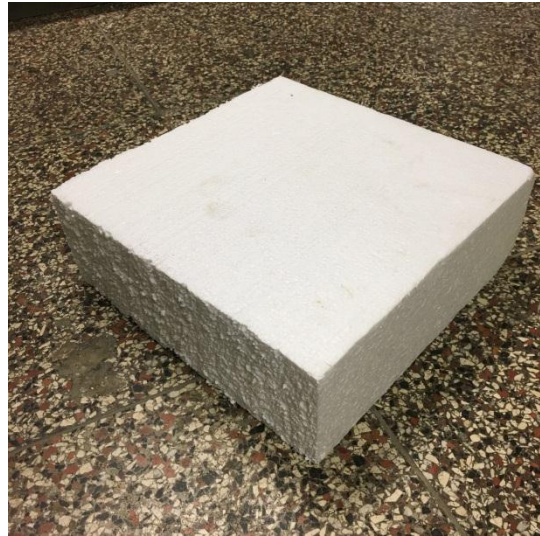
Obr. č. 6: Připravený vzorek tepelné izolace EPS (tl. 100 mm), rozměry: 300 x 300 mm
