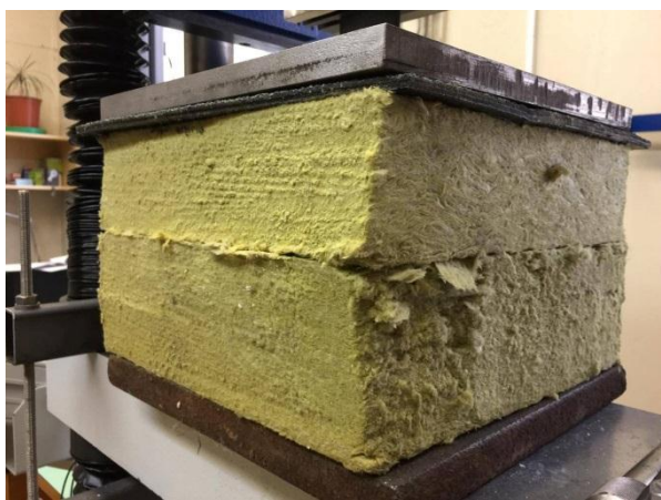
Obr. č. 35: Detail při plošném zatěžování vzorku z tepelné izolace ISOVER
