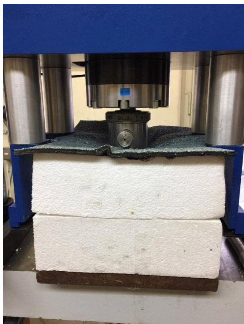
Obr. č. 20: Tlaková zkouška – bodová (tepelná izolace EPS) – průběh zkoušky
