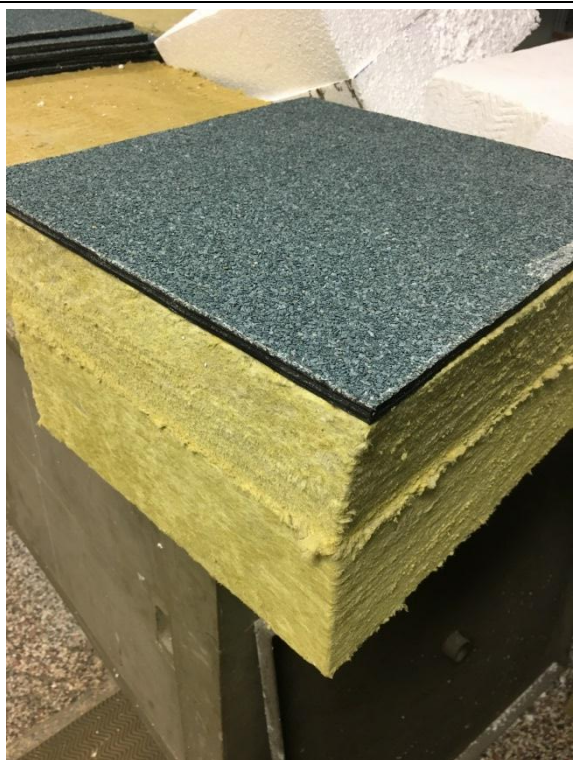
Obr. č. 8: Připravená skladba před navařením asfaltového pásu
