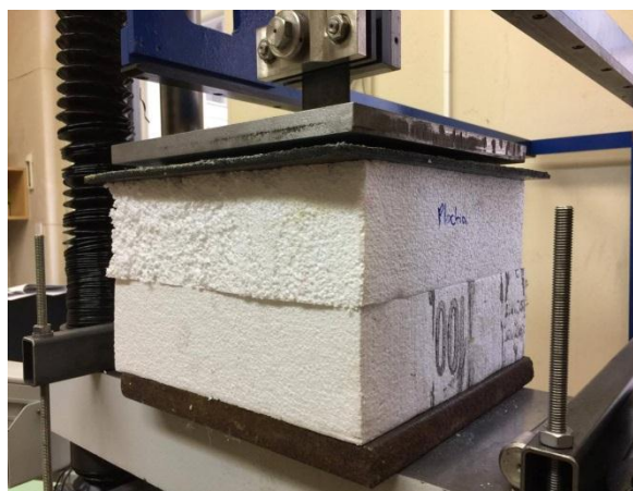
Obr. č. 32: Upevnění vzorku ve zkušebním zařízení (plošné zatěžování)
