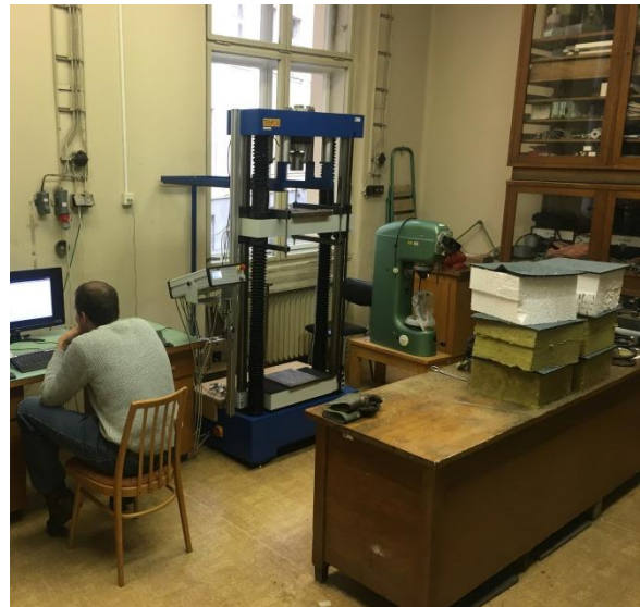
Obr. č. 27: Průběžné nastavování tlakového zařízení
