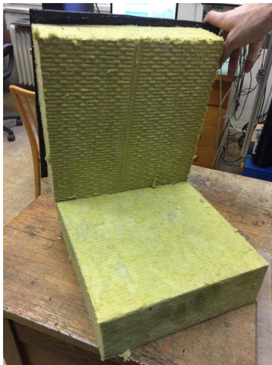
Obr. č 23: Výsledek bodového zatěžování – nepřítomnost poškození mezi jednotlivými izolacemi (pouze povrchové poškození asfaltového pásu a horní vrstvy tepelné izolace)
