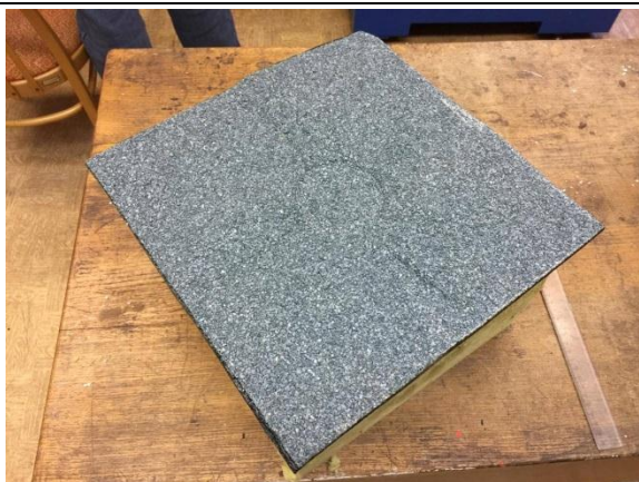
Obr. č. 30: Poškození asfaltového pásu bodovým zatěžováním
