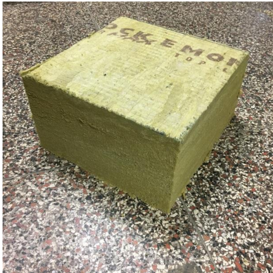
Obr. č. 5: Připravený vzorek tepelné izolace Monrock Max E (tl. 160 mm), rozměry: 300 x 300 mm
