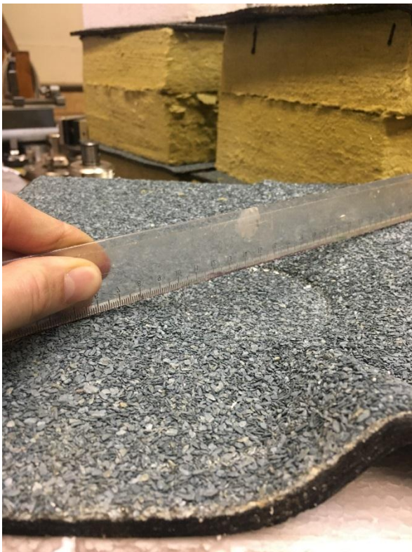
Obr. č. 24: Zkoušené vzorky – vlevo po zkoušce, vpravo před tlakovou zkouškou (bodovou)
