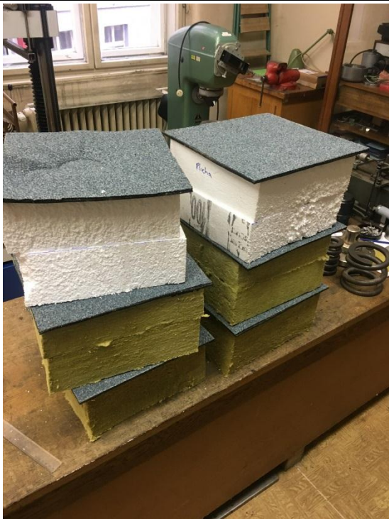
Obr. č. 24: Zkoušené vzorky – vlevo po zkoušce, vpravo před tlakovou zkouškou (bodovou)
