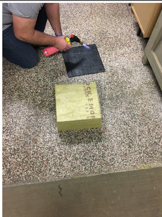
Obr. č. 9: Průběh navařování asfaltového pásu
