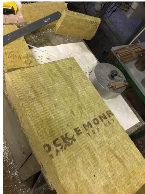
Obr. č. 2: Příprava vzorků (řezání na požadované rozměry)
