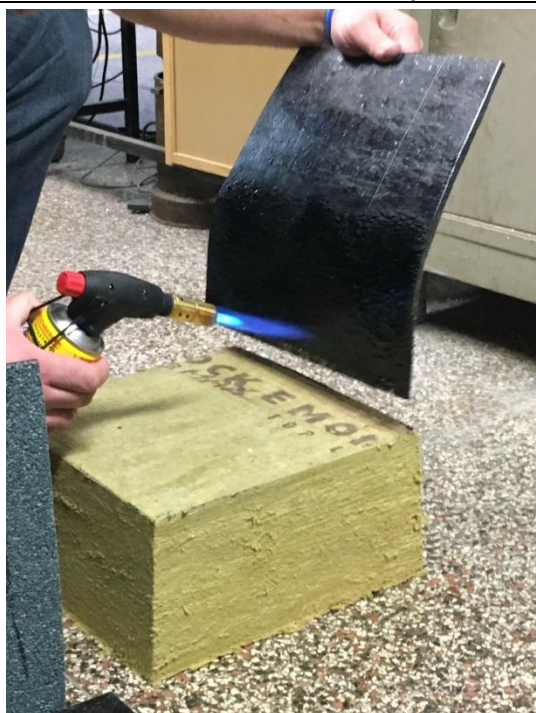
Obr. č. 8: Připravená skladba před navařením asfaltového pásu
