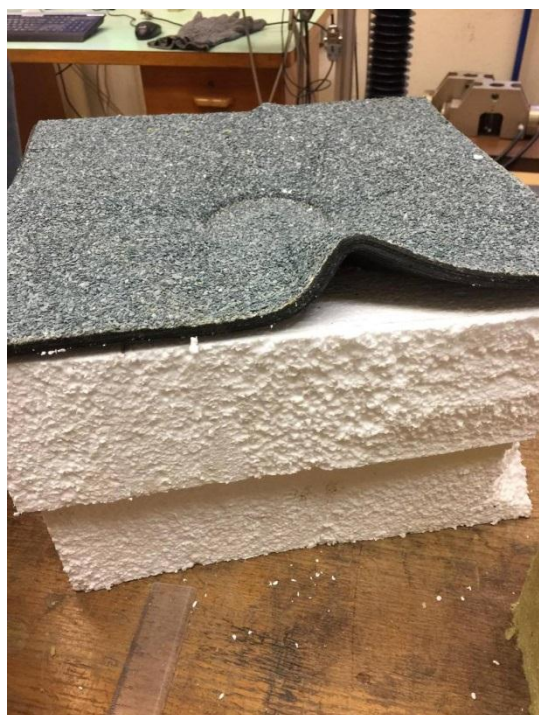
Obr. č. 22: Výsledek bodového zatěžování – povrchová deformace vzorku
