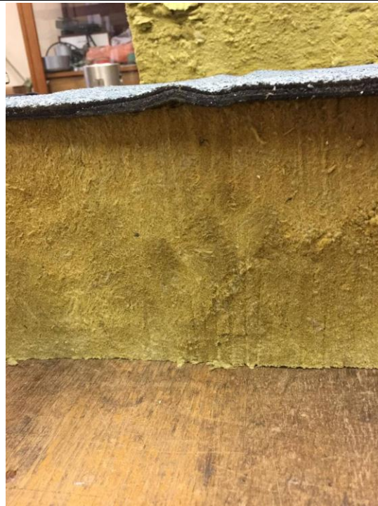
Obr. č. 29: Detail poškození od bodového zatěžování
