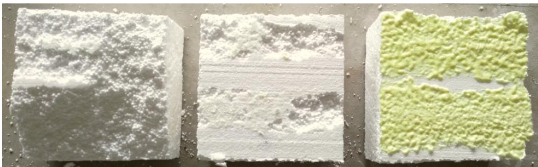
Obr. 29: Výsledky zkoušek – jednotlivé typy porušení
