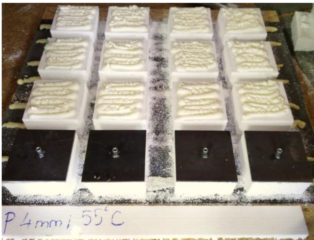
Obr. 19: Přilepování kotev na osamostatněné vzorky
