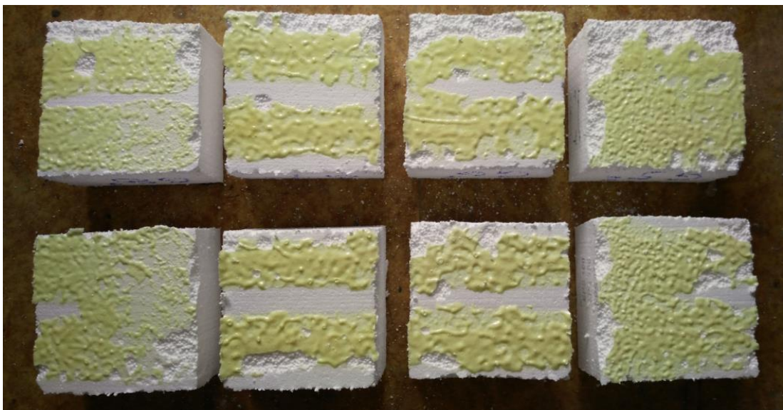
Obr. 28: Výsledek zkoušky – kohezní porušení v lepicí hmotě, lepidlo INSTA-STIK, 55°C
