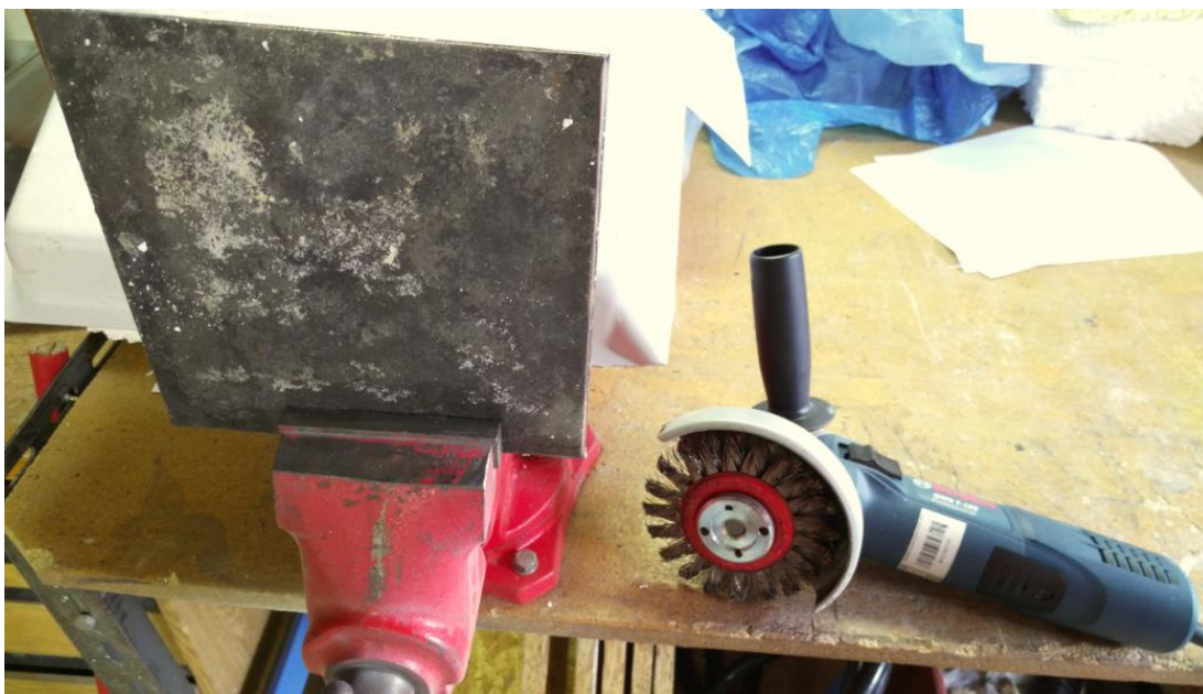
Obr. 20: Čištění kotvy od montážní pěny
