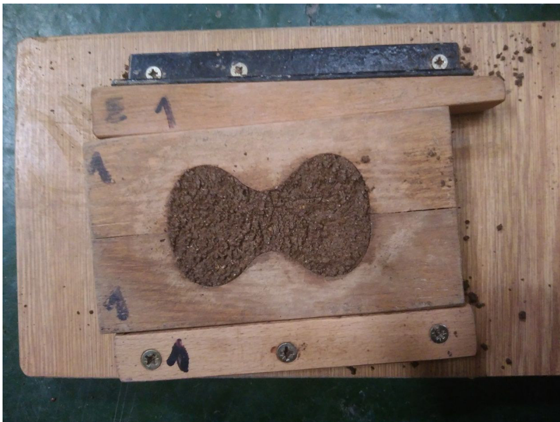
OBRÁZEK 14 Dřevěná forma ve tvaru osmičky se vzorkem I. nekomerční hliněnou omítkou pro zkoušku vaznosti (archiv autora)
