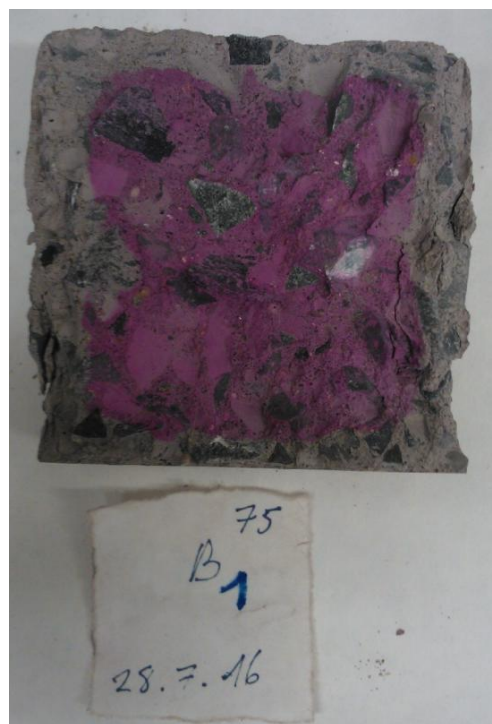
Obr. 3.13 – Označení hodnotou 15/6mm – vzorek B-FPC 75 B1
