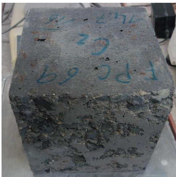
Obr. 3.3 – Porušený povrch krychle ze série B-FPC 69
