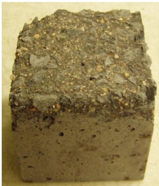
Obr. 3.11 – Vzorek B-FPC 58 C2 po zkoušce CHRL
