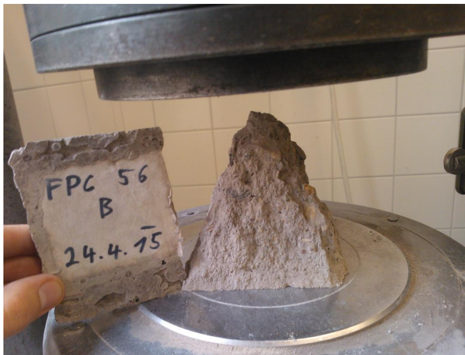
Obr. 3.6 – „Výbušné porušení“ [37] zkoušky pevnosti v tlaku dle ČSN EN 12390-3
