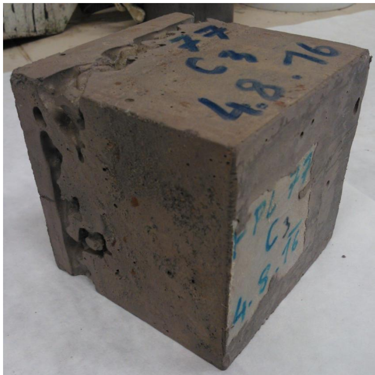
Obr. 3.4 – Porušený povrch krychle ze série B-FPC 77
