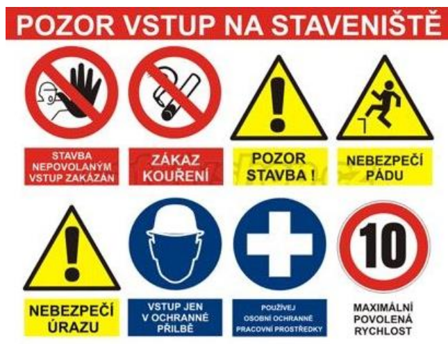
Obr 3, Ozn. vstupu na staveniště, zdroj: ČSN ISO 3864
