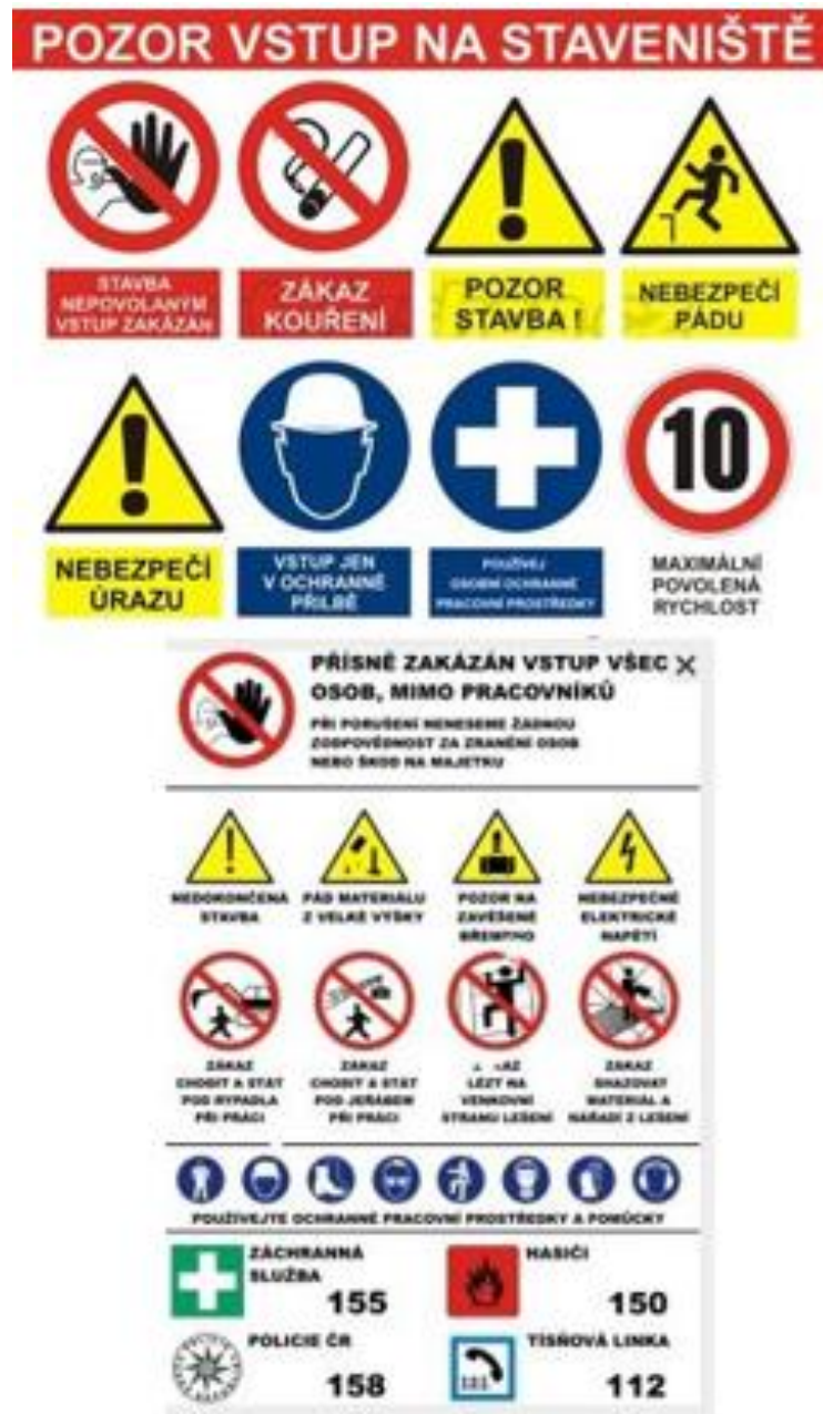
Obr. 9, Ozn. vstupu na staveniště, zdroj: ČSN ISO 3864
