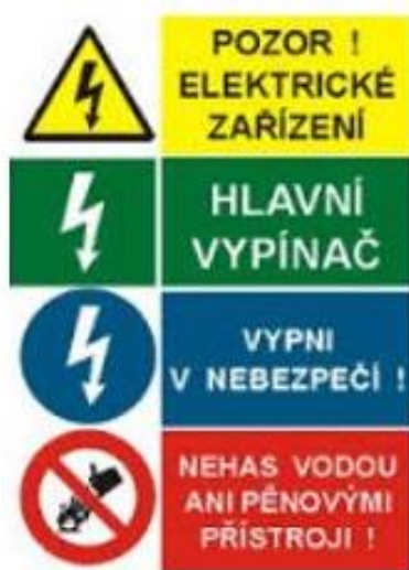
Obr. 10, Označení rozvaděče, zdroj: ČSN ISO 3864
