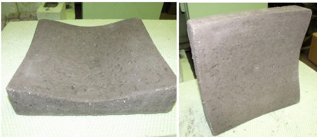
Obr. č. 31: Betonový prvek A po odformování, zdroj: vlastní
