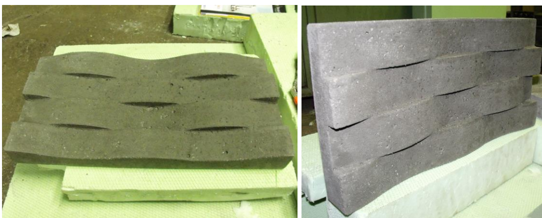
Obr. č. 32: Betonový prvek B po odformování, zdroj: vlastní
