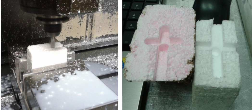
Obr. č. 21: Zkouška obrábění polystyrenů, zdroj: vlastní
