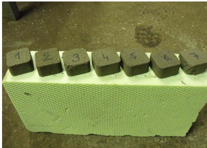
Obr. č. 28: Zkušební betonová tělíska po odformování zdroj: vlastní
