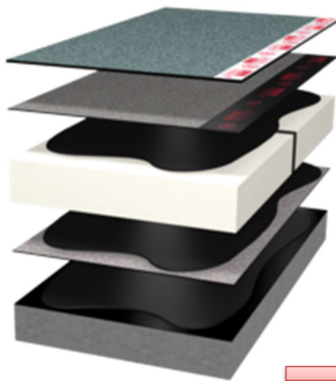
Obrázek 20 Šikmá kompaktní střecha na dřevěném bednění s tepelnou izolací PIR a s modifikovaným asfaltovým natavovacím pásem [62]
