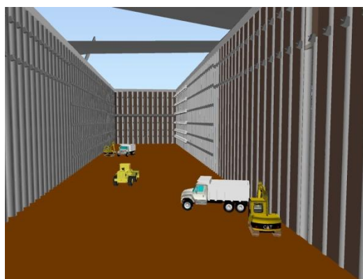
Obrázek 23: Pohled v zajištěné jámě
