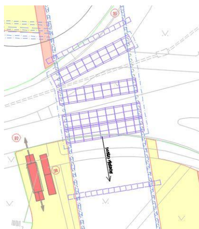
Obrázek 2: Přemostění pro silniční dopravu a přeložky sítí
