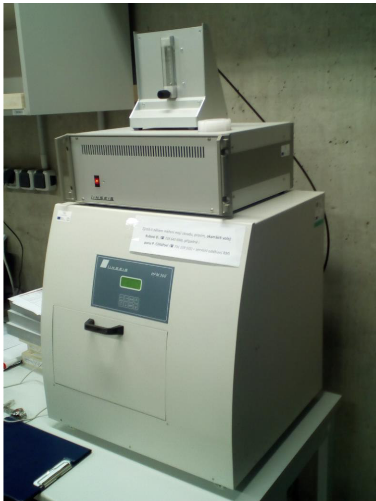
2.9 – Linseis HFM 300 – Heat Flow Meter, který byl použit pro měření součinitele prostupu tepla.
