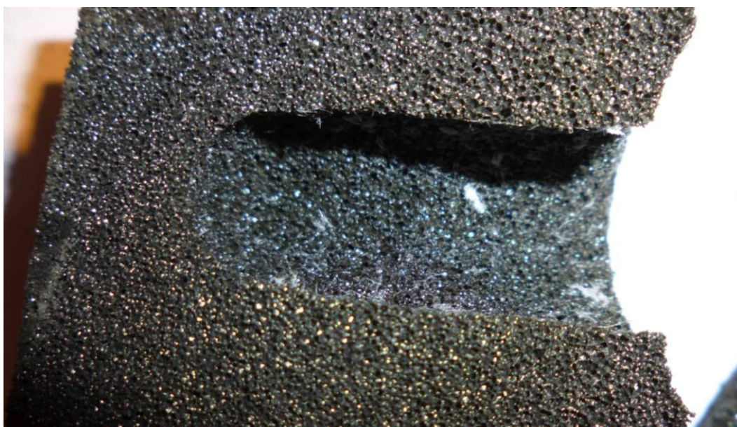
2.20 – Detailní pohled do lomu kostky z PS v okolí otvoru, který byl vystaven tlakové vodě.
