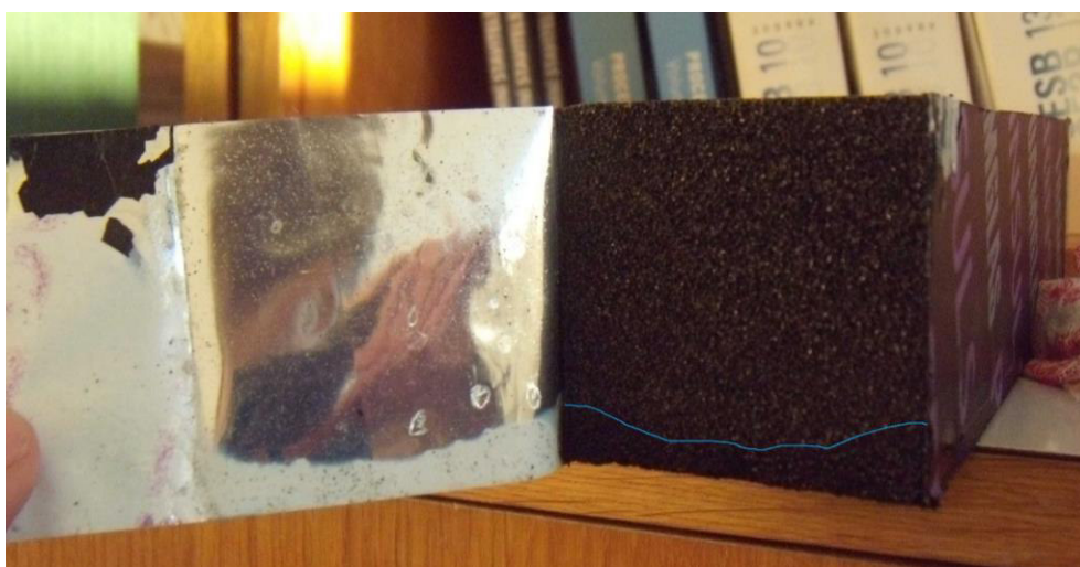
2.13 – Na fotografii je modře vyznačena úroveň vody, která vzlíná pod záplekou.
