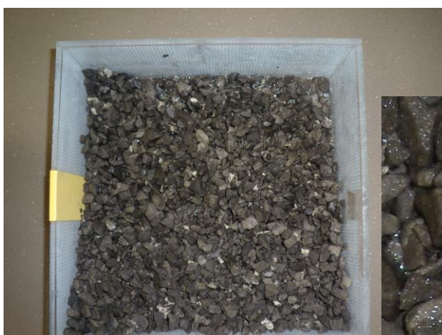
2.6 – Spodní vrstva vzorku C1 (vlhkost na povrchu)
