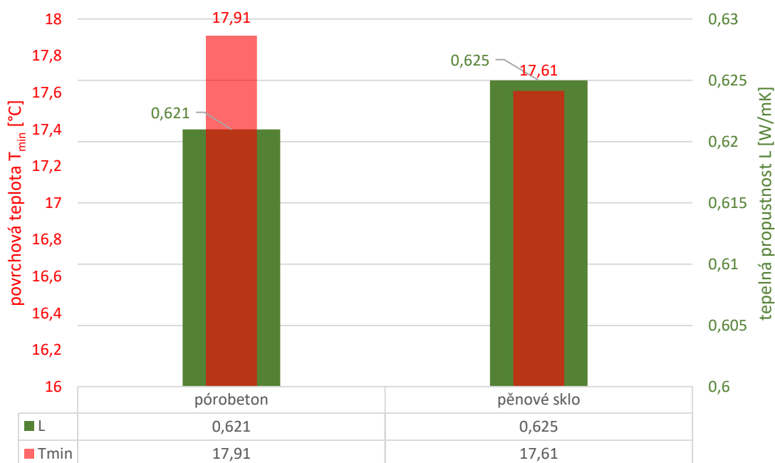
Graf 3.1 – Graf porovnání povrchové teploty a tepelné propustnosti pórobetonu a pěnového
