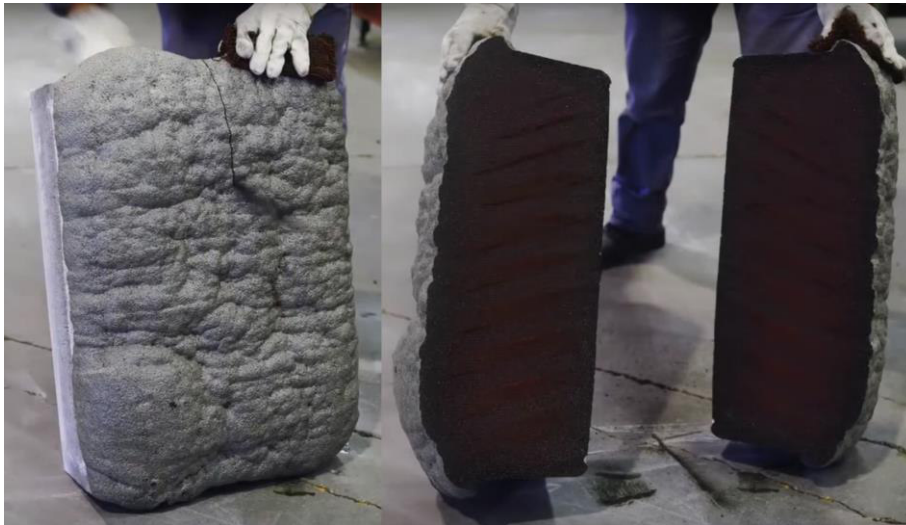
1.4 – Řez vypěněným sklem po vyjmutí z formy
