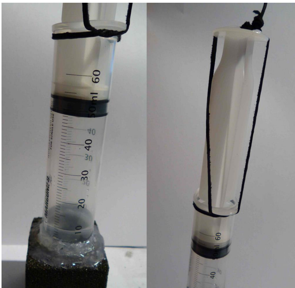
2.17 – Fixování pístu stříkačky – vzduch je stlačen na objem 39ml.
