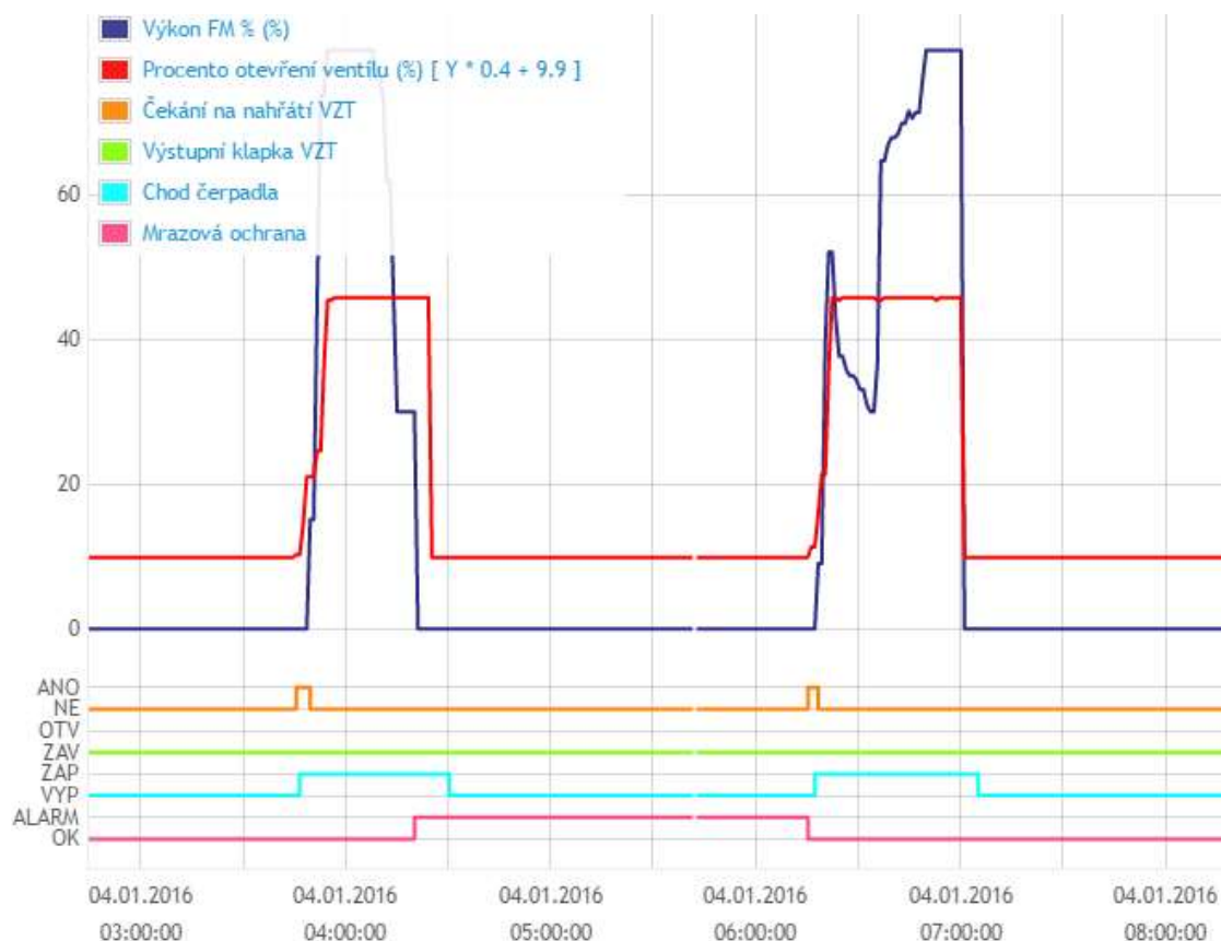
Obrázek 13: První spuštění mrazové ochrany předchází signálu mrazová ochrana. (ČVUT 1)
