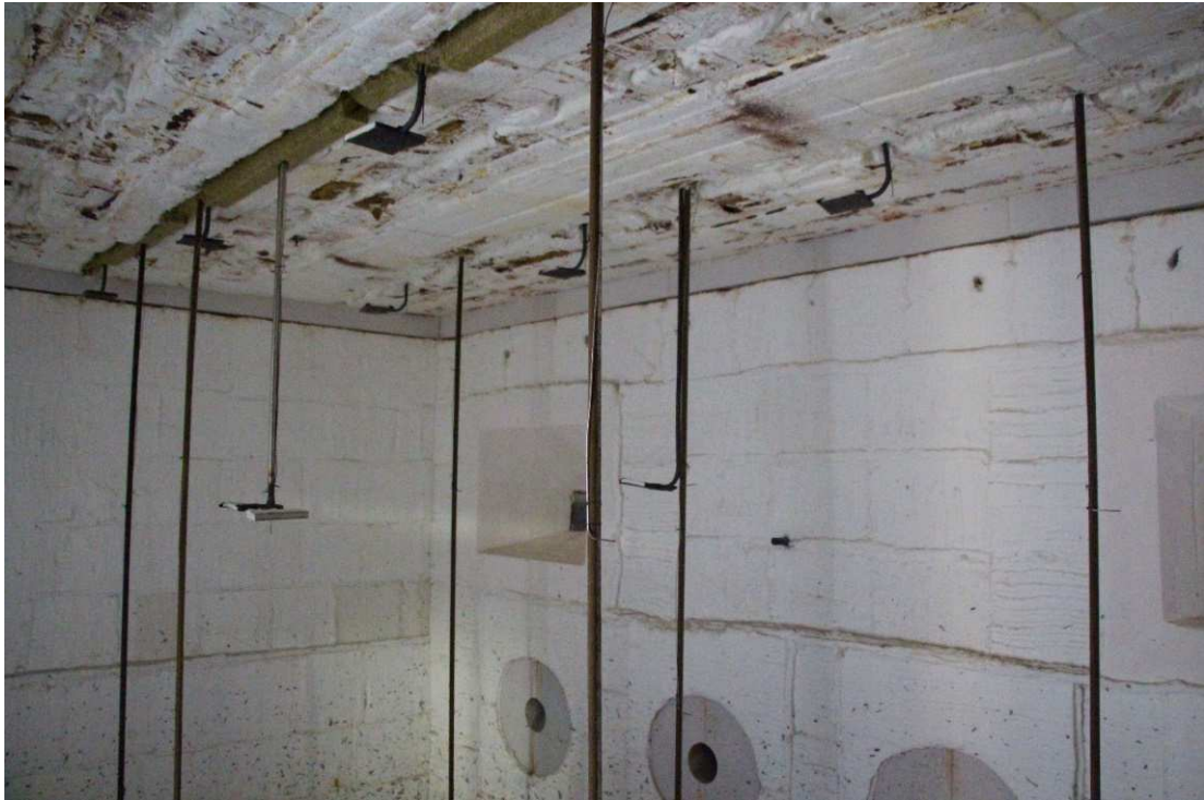
Obr. 10 Rozmístění plášťových termočlánků a deskových snímačů teploty v prázdné peci
