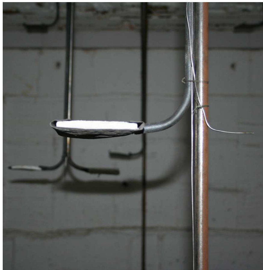
Obr. 11 Detail deskového snímače teploty a plášťového termočlánku
