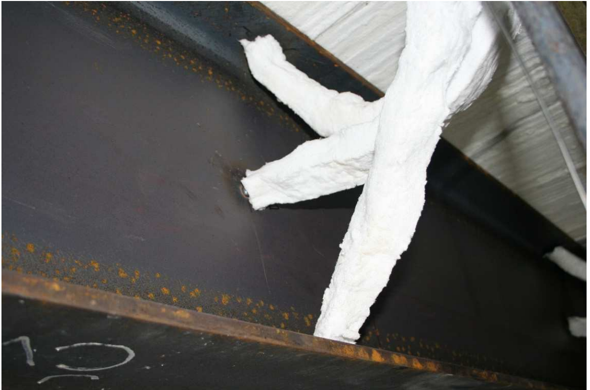
Obr. 16 Detail napojení TC na nosník.
