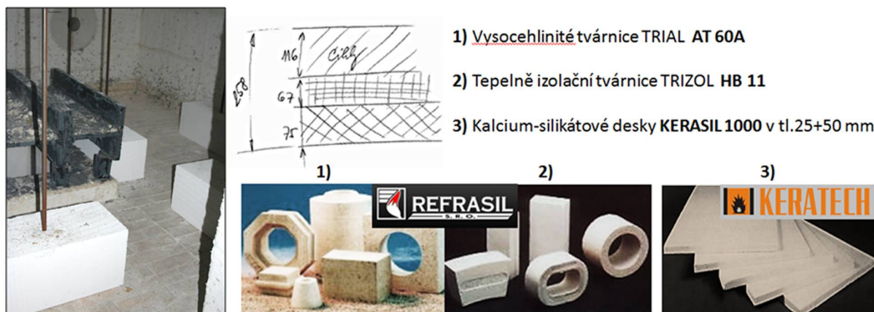
Obr. 22: Skladba podlahy pece H2
