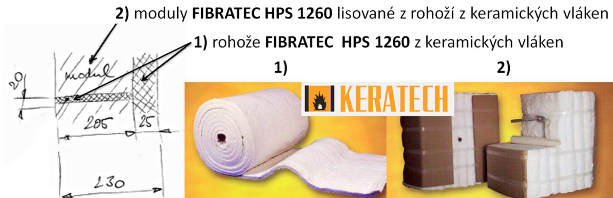
Obr. 21: Skladba stěn pece H2
