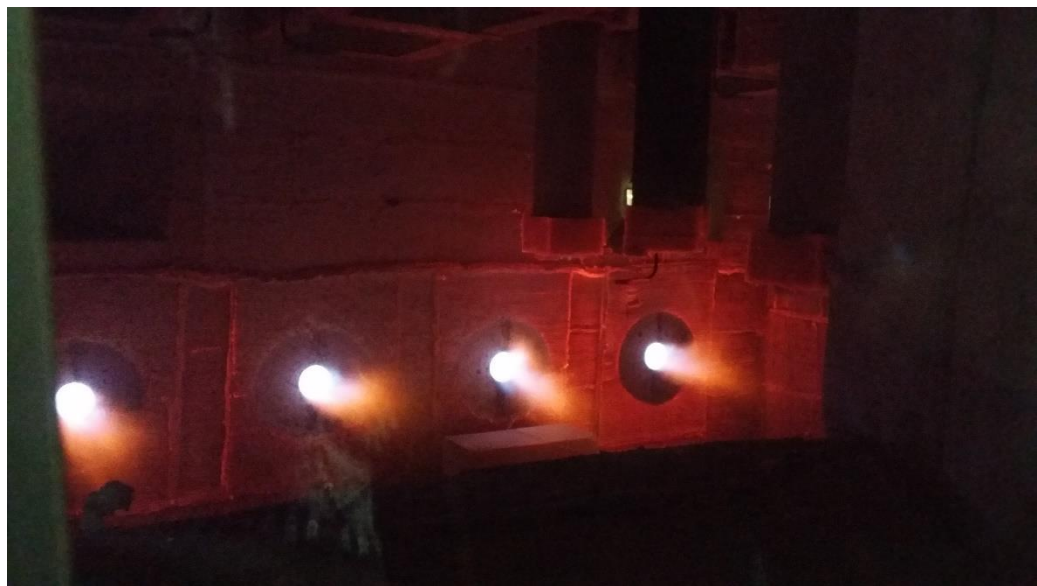
Obrázek 59. Počátek zkoušky – hořáky v peci (Vlastní 2016)
