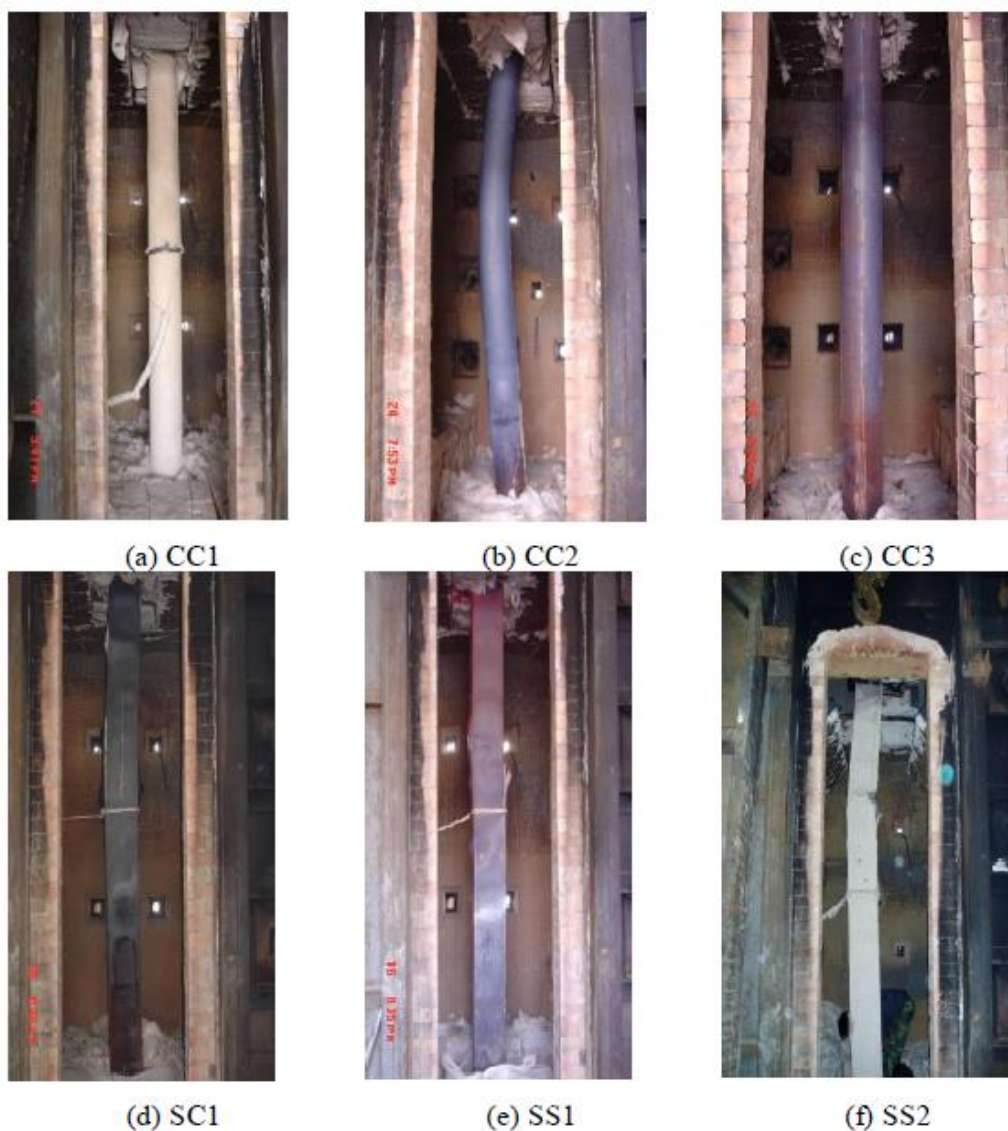
Obr. 15 Režimy kolapsu všech vzorků (Lu a další, 2010).
