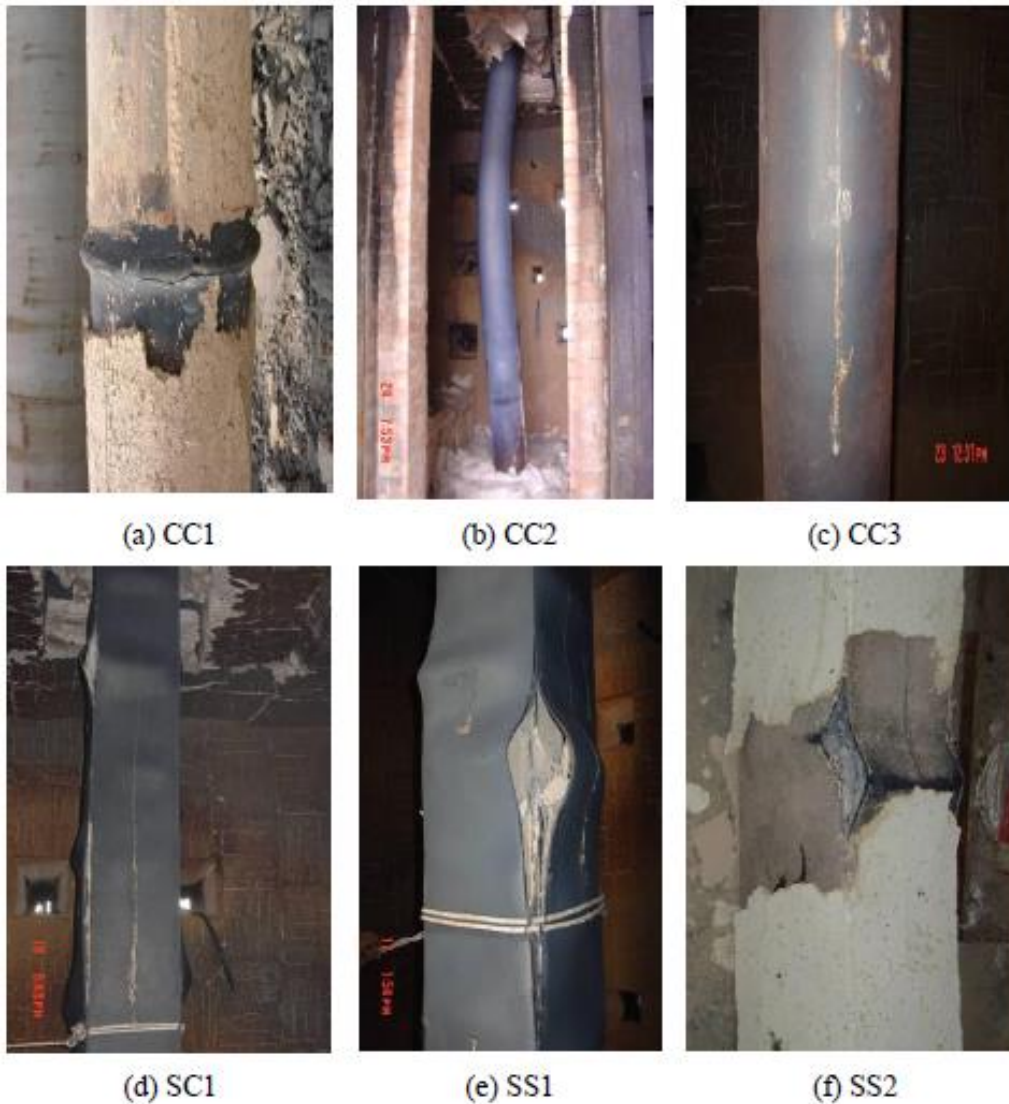
Obr. 16 Ukázky lokálního vyboulení u jednotlivých vzorků (Lu a další, 2010).
