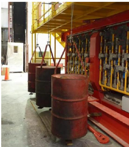
Obrázek 51 - Fotografie sudů zobrazující boční zatížení u protipožární zdi (23)
