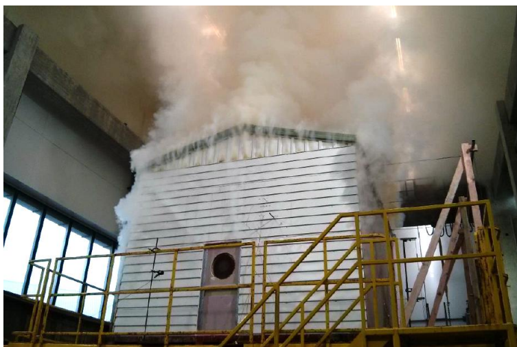
Obrázek 55 - Fotografie objektu po selhání podhledové konstrukce (cca 16 minut od začátku experimentu) (23)
