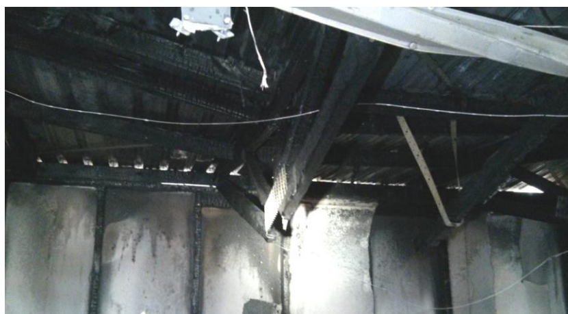
Obrázek 57 - Fotografie selhání prostředního vazníku (T3) po experimentu (23)
