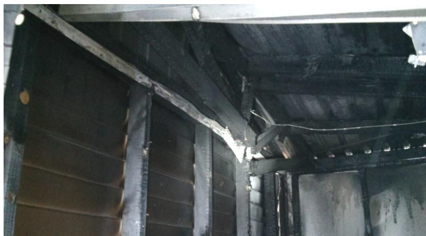
Obrázek 58 - Fotografie selhání vazníku na konci (T5) po experimentu (23)
