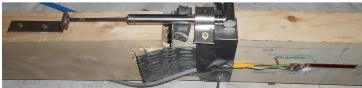
Obrázek 19 - Typické porušené spoje po vytáhnutí ze zatěžovacích čelistí (10)
