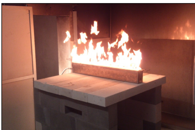
Zkouška plynového hořáku po dostavbě zkušební pece
