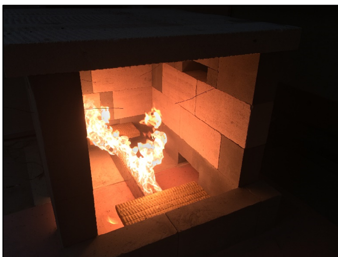
Zkouška plynového hořáku před referenční zkouškou
