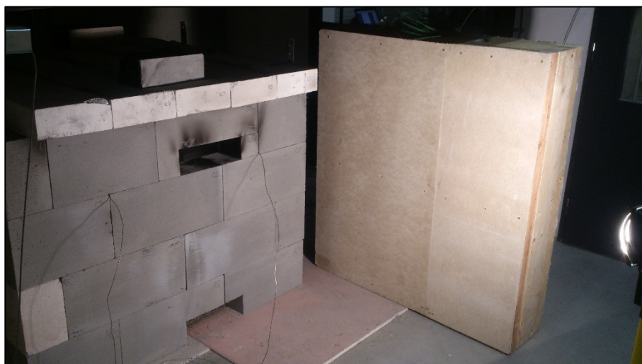
Umístování zkušební vzorku obvodové stěny Diffuwall
