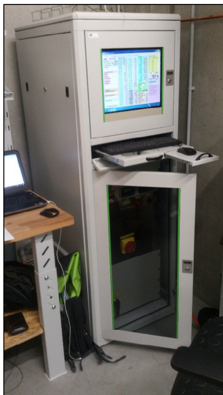
Řídicí jednotka požární zkoušky
