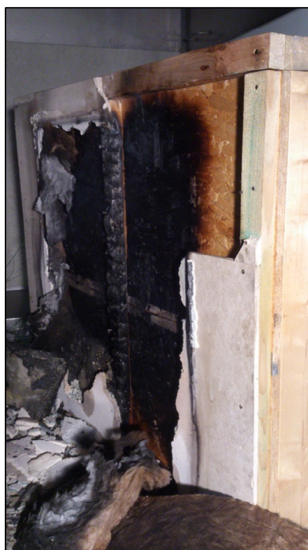
Uhašený zkušební vzorek stěny Diffiwall
