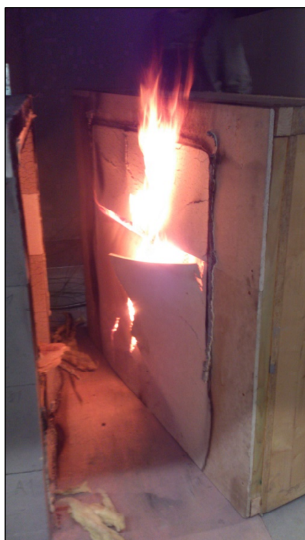
Ukončování zkoušky požární odolnosti
