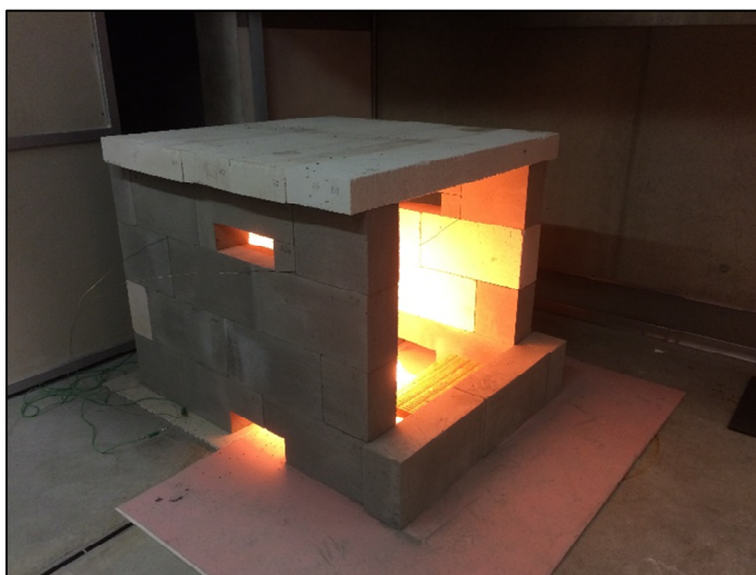
Zkouška plynového hořáku před referenční zkouškou
