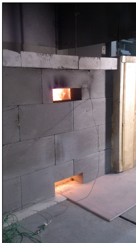
Boční pohled na zkušební pec v průběhu zkoušky
