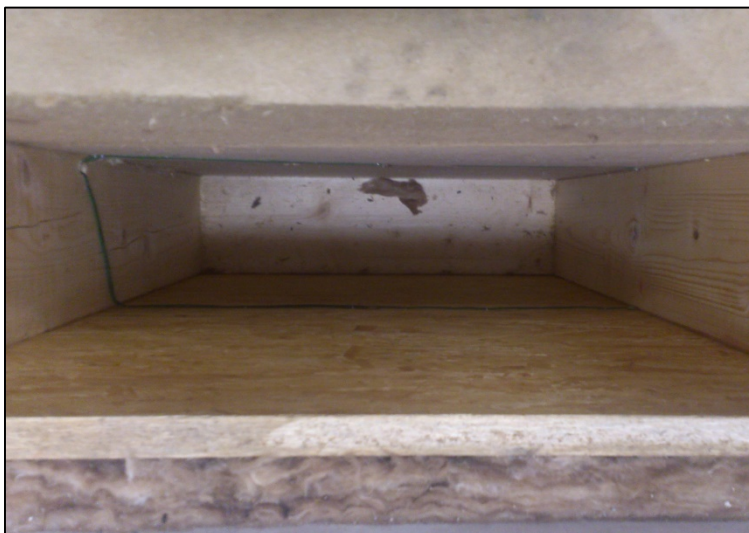
Obr. 22 Umístění termoelektrických článků uvnitř zkušební vzorku
