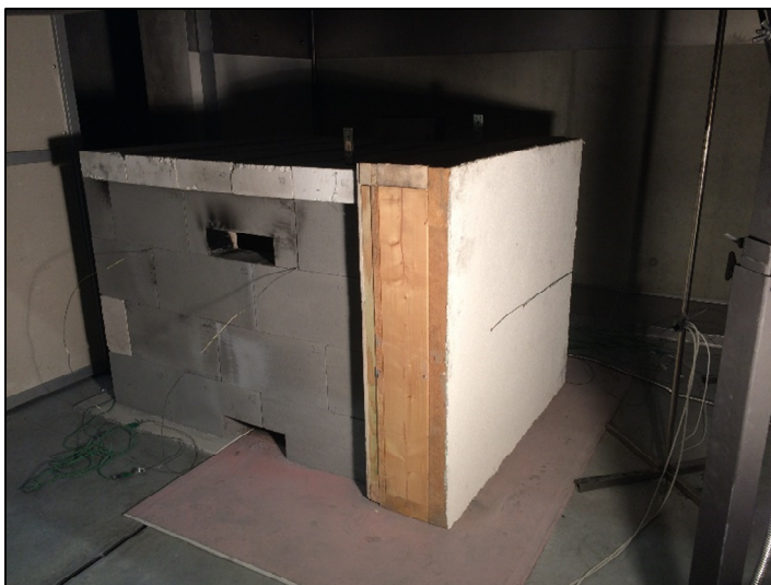
Obr. 24 Umístění termoelektrický článků na vnějším povrchu a radiometru
