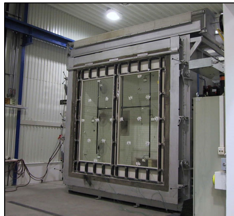
Obr. 6 Zkouška požární odolnosti protipožárního zasklení oken [9]
