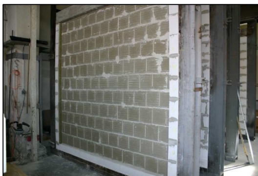
Obr. 5 Zkouška požární odolnosti zděné stěny [6]
