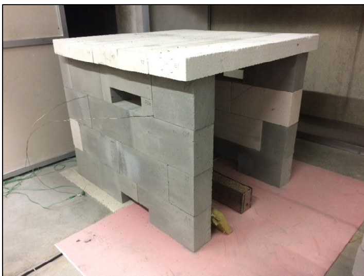
Obr. 14 Reálný model zkušební pece bez zakryté přední strany
