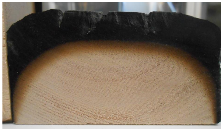
Obrázek 7 Zmenšení průřezu dřevěného trámu vlivem odhořívání dřevní hmoty. (foto Ing. Lukáš Blesák, Ph.D.)
