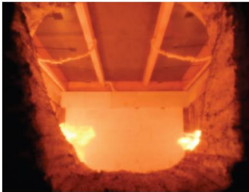
Obrázek 8 Dřevo-betonová stropní konstrukce vystavená požáru (10)
