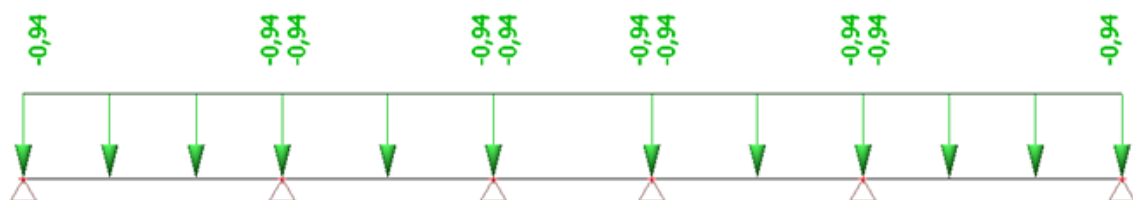
Obrázek B.3.5-5 - ZS4 – užité zatížení 1 – kategorie A (viz. str. 15) [kN/m]
