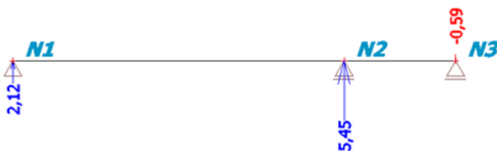
Obrázek B.3.3-12 - Reakce R [kN] - kombinace CO1 - proměnné zatížení (ZS4)
