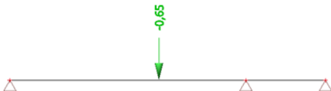
Obrázek B.3.3-4 - ZS3 – příčky – stálé zatížení (viz str. 19) [kN]
