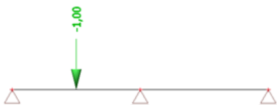
Obrázek B.3.1-4 - ZS3 – obsluha (1 stojící dělník) [kN]
