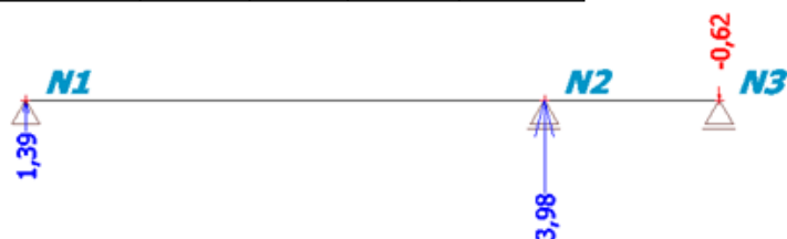
Obrázek B.3.3-11 - Reakce R [kN] - kombinace CO1 - stálé zatížení (ZS1+ZS2+ZS3)
