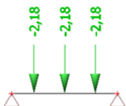
Obrázek B.5.5-5 - ZS4 – stropní trám – char. reakce od užitečného zatížení ze stropních trámů (viz. obr. B.3.4-12) [kN]
