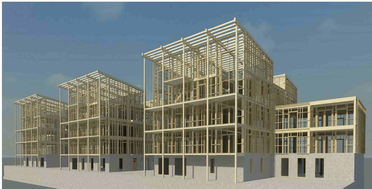
Obr.[7] Renderovaný model varianty masivního skeletu
