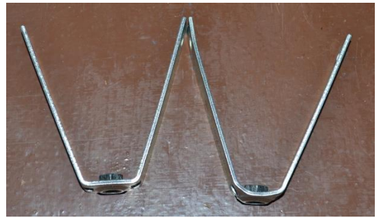
Obrázek 63: Porovnání závěsů před zkouškou (vlevo) a po zkoušce (vpravo)
