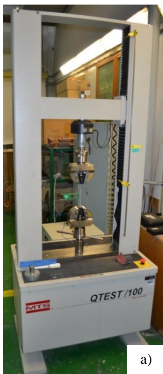
Obrázek 89: a) Zkušební stroj MTS QTEST/100; b) Uchycení vzorků do čelistí a umístění extenzometru; c) vytvoření krčku
