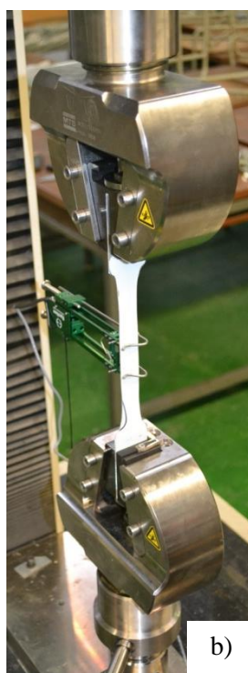
Obrázek 89: a) Zkušební stroj MTS QTEST/100; b) Uchycení vzorků do čelistí a umístění extenzometru; c) vytvoření krčku
