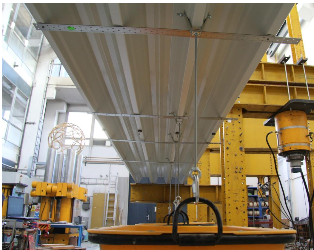
Obrázek 72: Pohled na spodní líc trapézového plechu s přišroubovanými příčnými táhly
