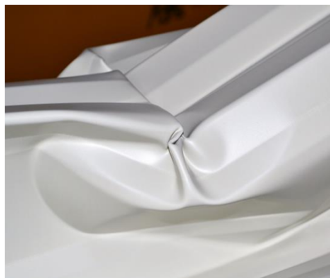
Obrázek 84: Detail plastické deformace vlny trapézového profilu
