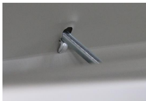
Obrázek 83: Detail otlacení otvorů pro závlače
