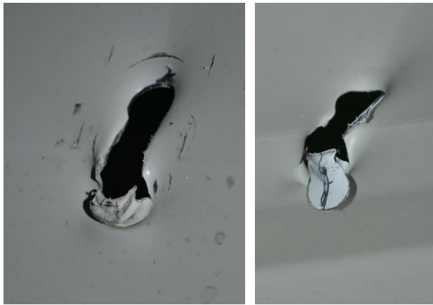
Obrázek 62: Otláčení otvoru pro závač (pohled z obou stran po vyjmutí závlače ze vzorku)
