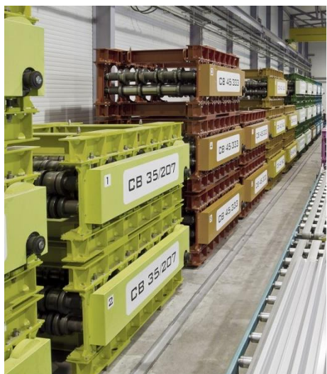
Obrázek 5: Pohled na sady válců nastavených pro různé typy profilů [2]
