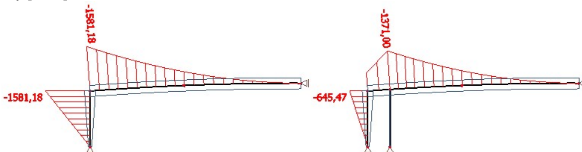
Obr. 4: Vnitřní síly na zkušební konstrukci
