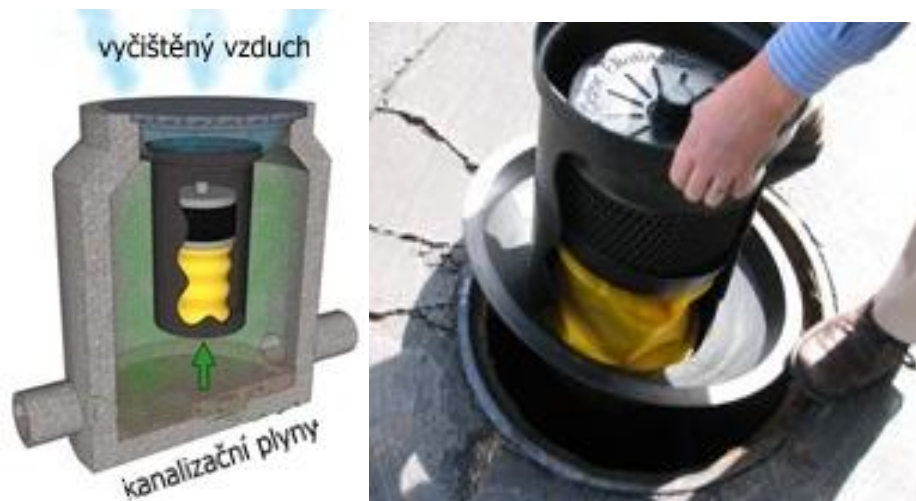
Obrázek 12: Schéma a osazení Manhole odor eliminatoru [58]
