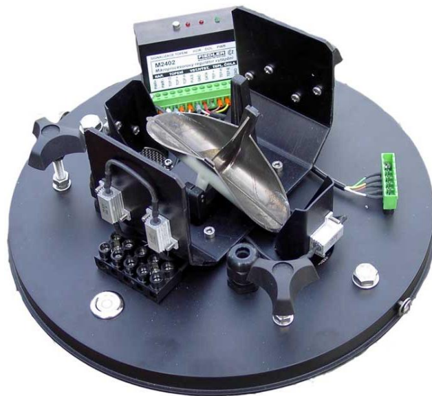
Obrázek 8: Mechanická část člunkového dešťoměru [47]
