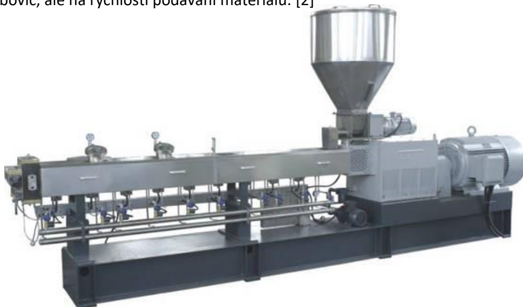
Obrázek 13 - Linka s dvojitou šroubovicí rotující ve stejném směru [19]
