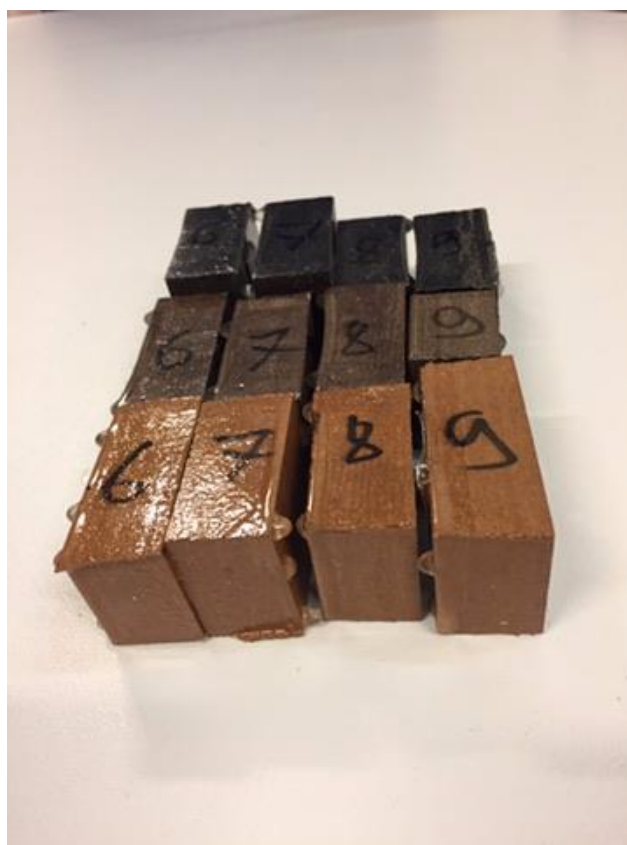
Obrázek 16 - Připravené zaepoxidované vzorky
