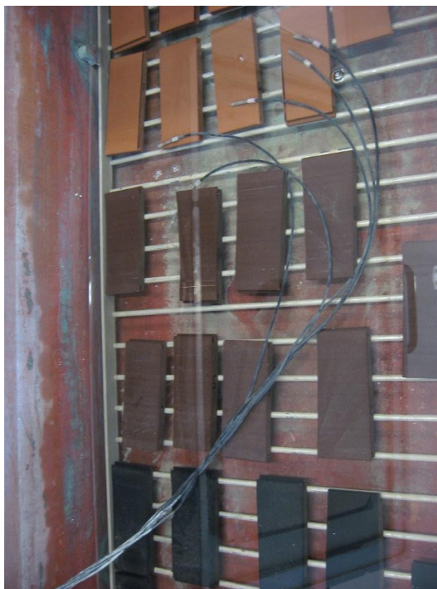
Obrázek 26 - Vzorky uložené v zmrazovací komoře
