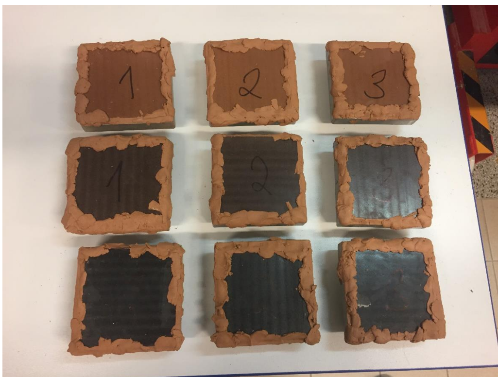
Obrázek 21 - Vzorky utěsněné a připravené na vložení do komory
