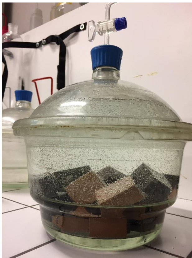
Obrázek 19 - Vzduch "vysávaný" ze zkušebních vzorků
