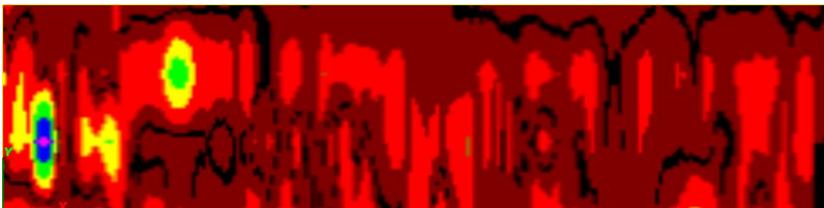
Obrázek 16 Kruhová věž - půdorysný řez v hloubce 0,2m
