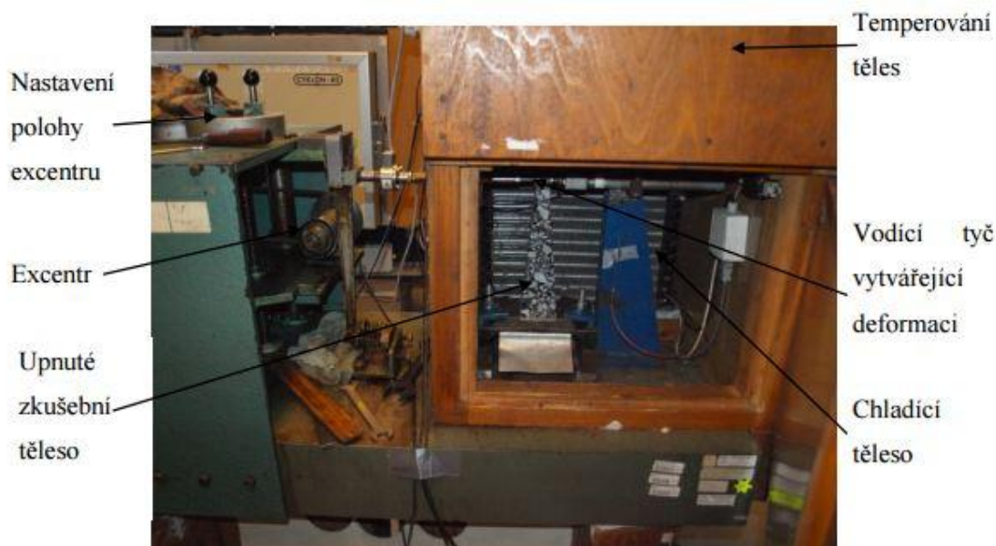
Obrázek 2.1.1.4 Přístroj na měření modulu tuhosti [5]
