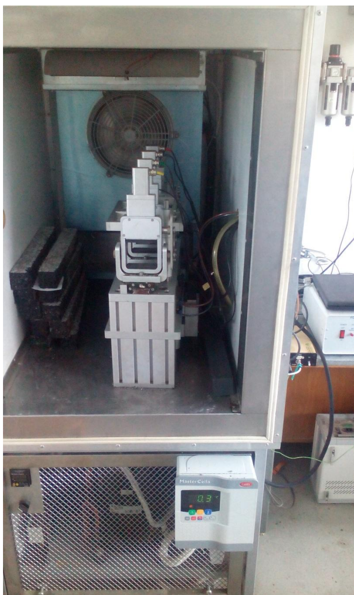
Obrázek 2.1.3.3 4PB-PR zařízení v klimatizační komoře
