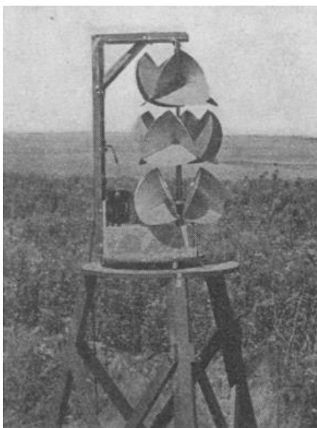
Obrázek 7: Speciální trojitý rotační reflektor použitý Stockmannem [13]
