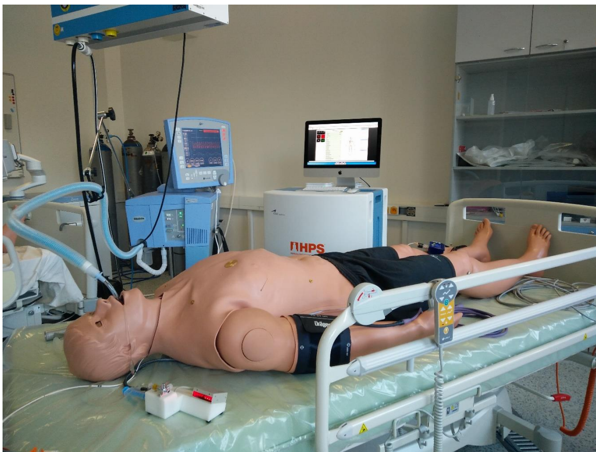
Obrázek 14: Realizace propojení přístrojů pro demonstraci zpětnovazebního řízení ventilátoru se simulátorem HPS. Zdroj: Autor.
