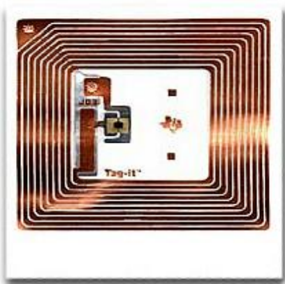
Obrázek 14: Schéma konstrukce RFID čipu [Neuwirt, 2010]
