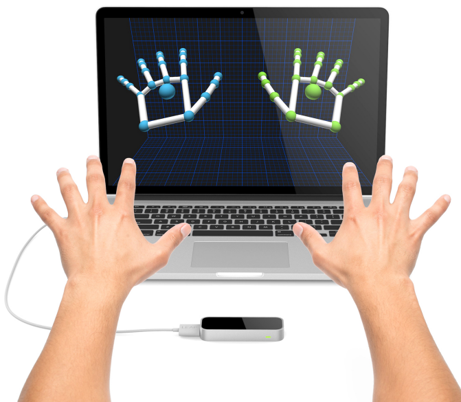
Obrázek 2.8: Schéma ovládání počítače systémem Leap Motion [23]
