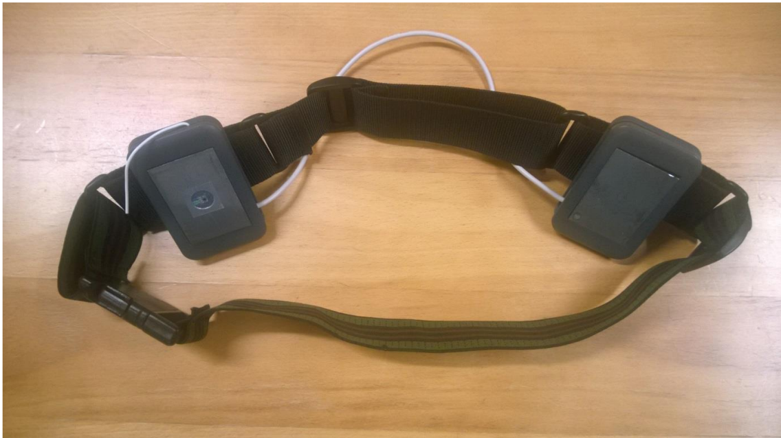
Obr. 10: Hrudní pás systému FlexiGuard se snímacími jednotkami [17]
