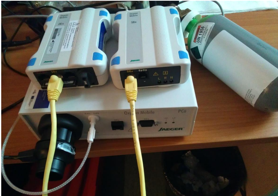
Obr. 6: Jednotky systému OxyconMobile s tlakovou lahví s kalibračním plynem – vlastní tvorba
