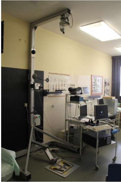
Obr. 4.1: Kamerový systém umístěný v FN Motol (vlevo) (přejato z Vlčková K (2014)) a helma (vpravo), kde 1 – infračervená LED dioda, 2 – gyroskopický snímač, 3 – posuvná lišta (přejato z Hejda J. et al (2012))
